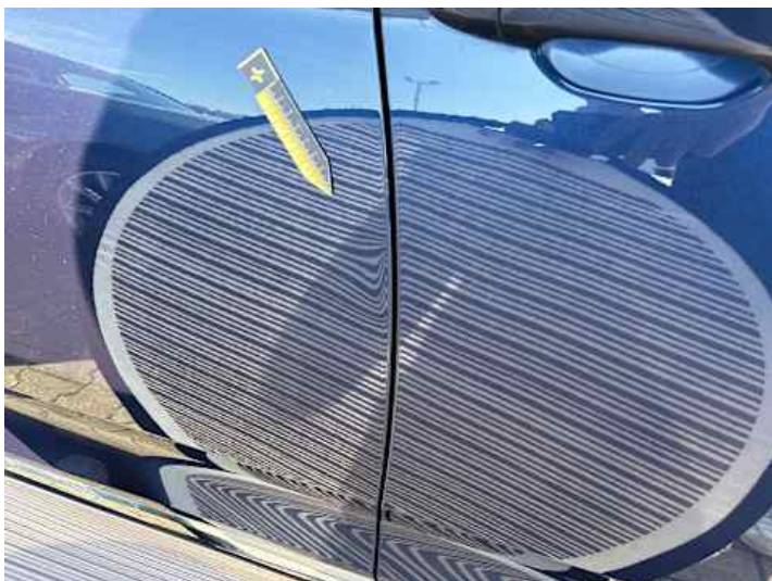
Türe hinten rechts (Lackschaden, Verformung)
