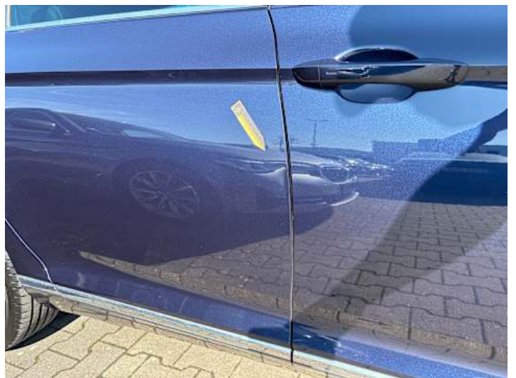
Türe hinten rechts (Lackschaden, Verformung)
