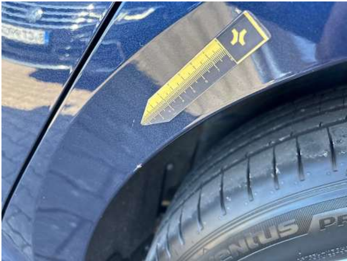
Seitenteil hinten links (Lackschaden, Kratzer)
