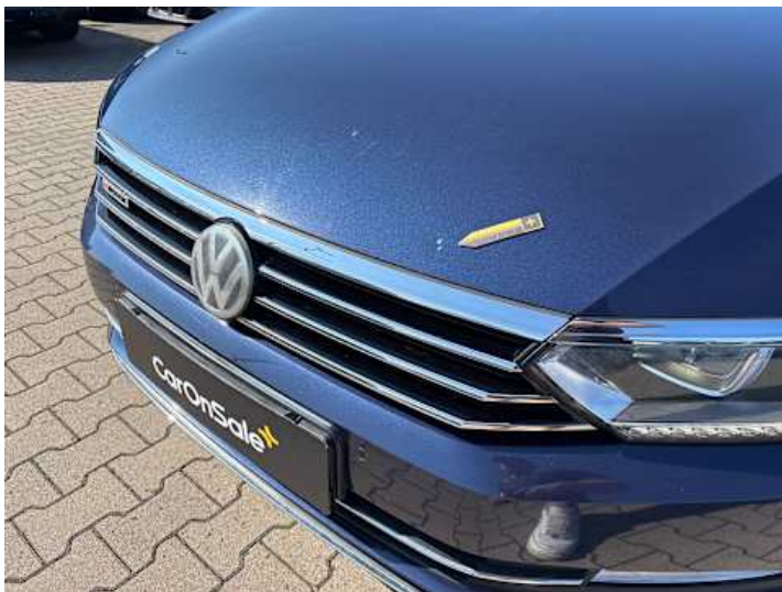
Motorhaube (Lackschaden, Rost)
