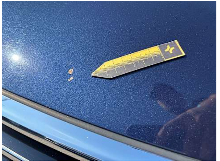
Motorhaube (Lackschaden, Rost)
