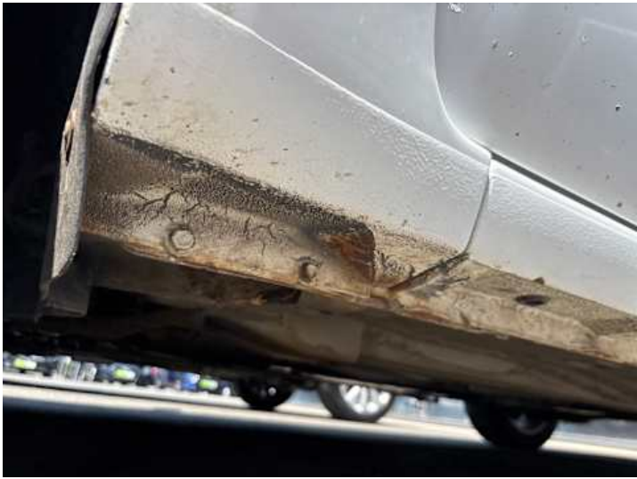
Schweller links (Rost)
