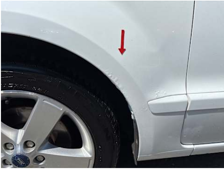
Kotflügel vorne links (Rost)
