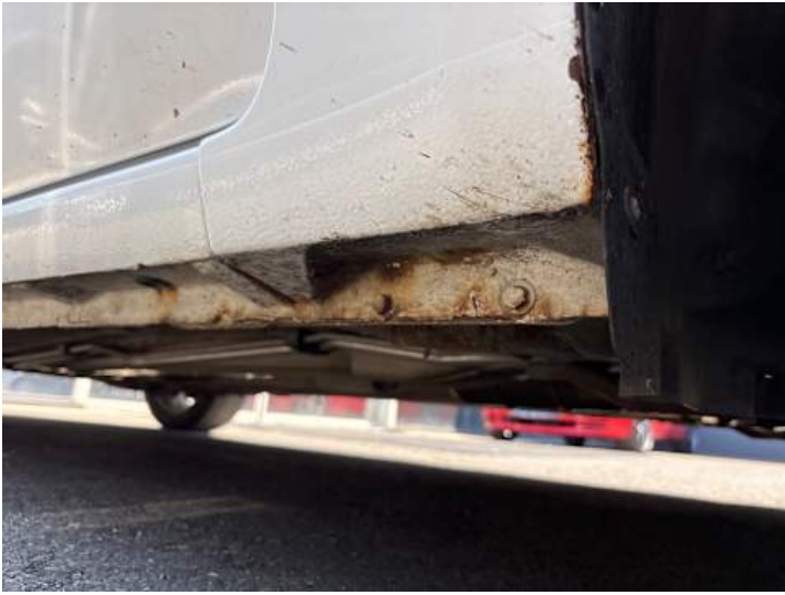
Schweller rechts (Rost)
