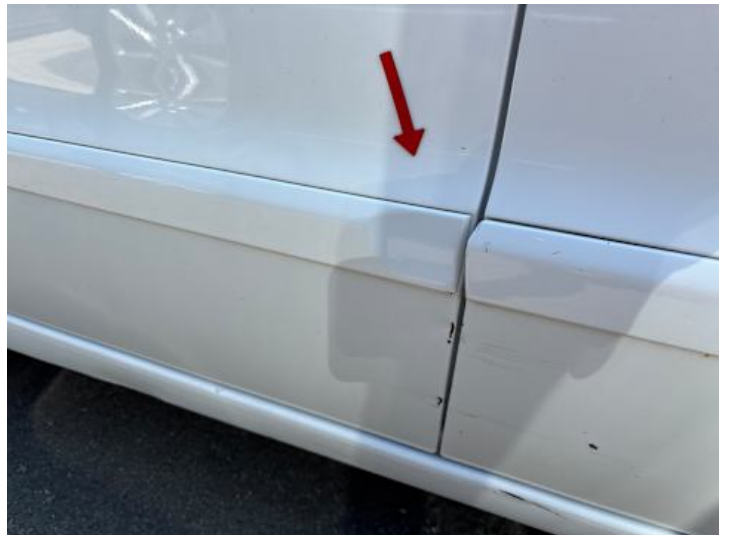
Türe hinten rechts (Kratzer, Lackschaden)
