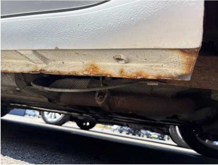
Schweller links (Rost)
