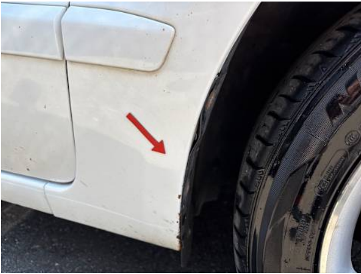
Kotflügel vorne rechts (Rost)
