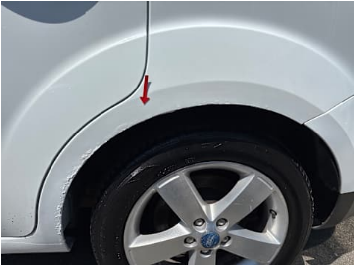
Seitenteil hinten links (Rost)
