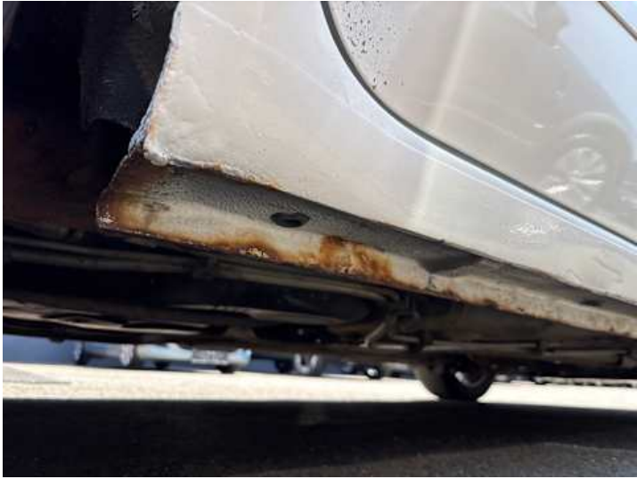
Schweller rechts (Rost)
