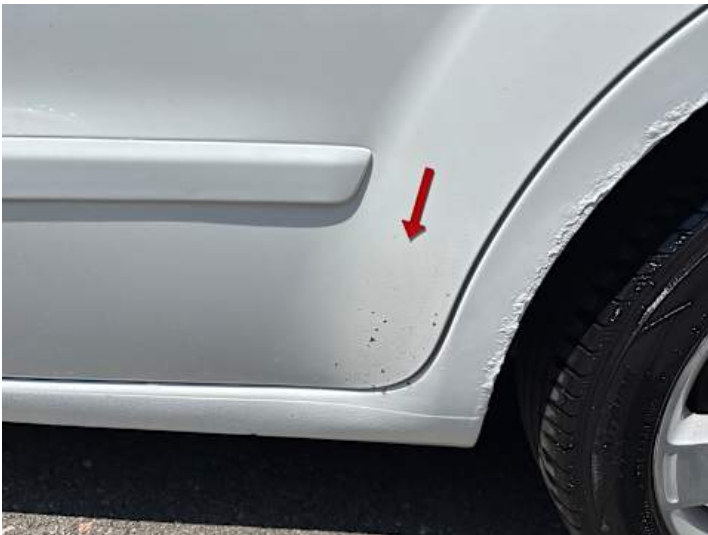
Türe hinten links (Kratzer, Lackschaden)
