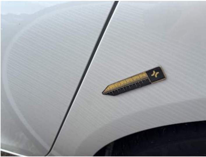
Seitenteil hinten links (Delle)
