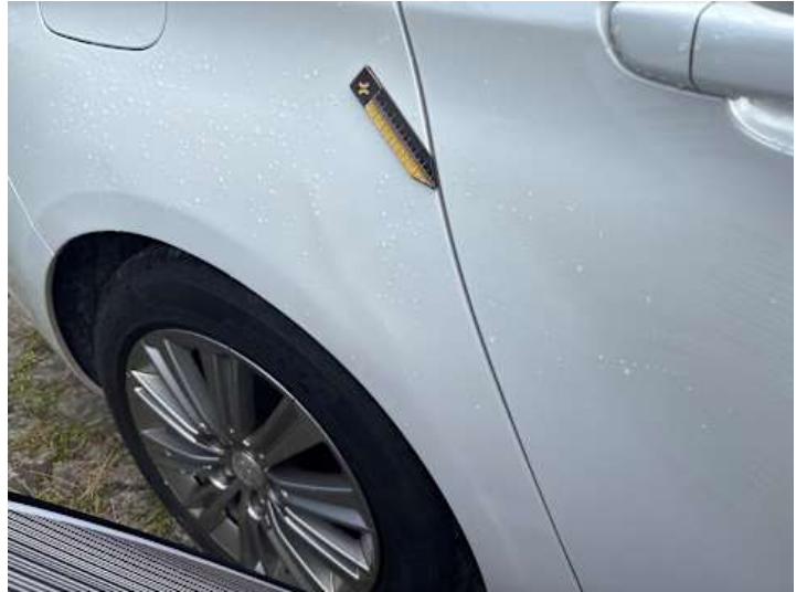
Seitenteil hinten rechts (Unsachgemäß instand gesetzt)
