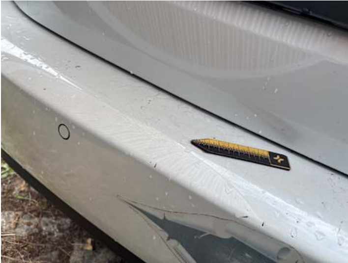
Stoßstange hinten (Verformung)
