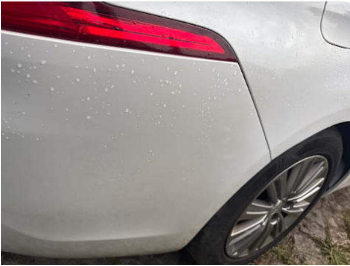
Stoßstange hinten (Unsachgemäß instand gesetzt)
