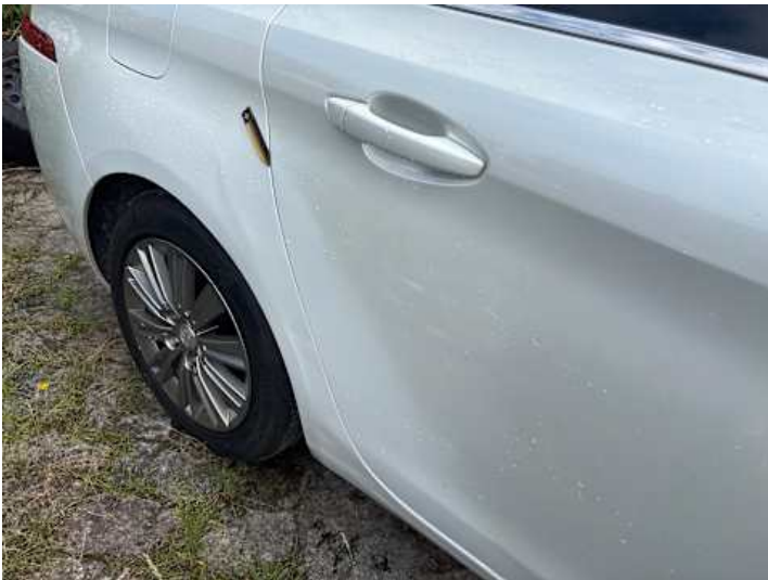
Seitenteil hinten rechts (Unsachgemäß instand gesetzt)
