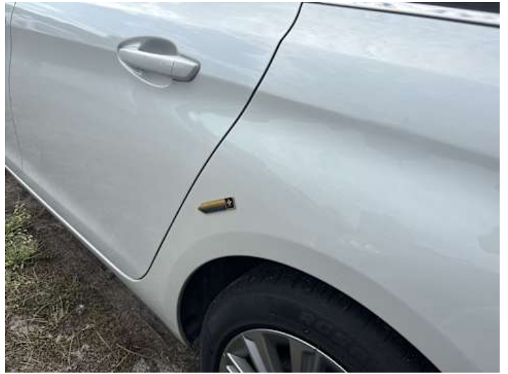
Seitenteil hinten links (Delle)
