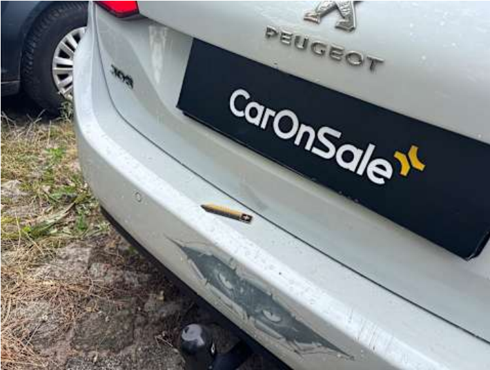
Stoßstange hinten (Verformung)
