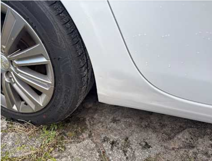
Seitenteil hinten rechts (Unsachgemäß instand gesetzt)
