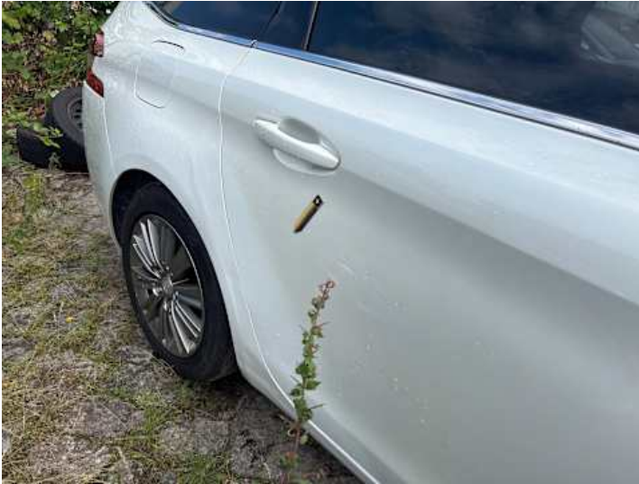
Türe hinten rechts (Unsachgemäß instand gesetzt)
