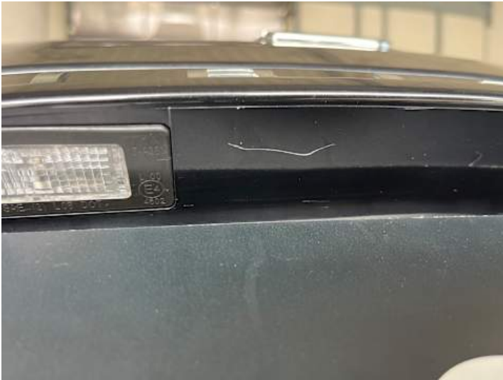
Heckklappe (Kratzer, Lackschaden)
