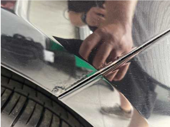
Seitenteil hinten links (Lackschaden, Rost)
