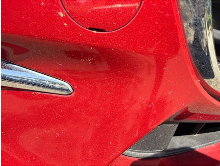
Stoßstange vorne (Lackschaden, Steinschlag)
