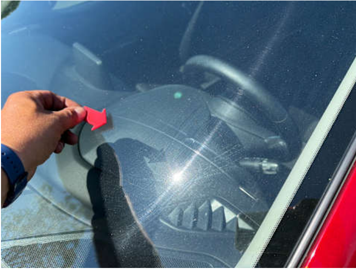
Windschutzscheibe (Steinschlag, Kratzer)
