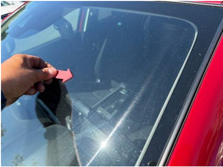
Windschutzscheibe (Steinschlag, Kratzer)
