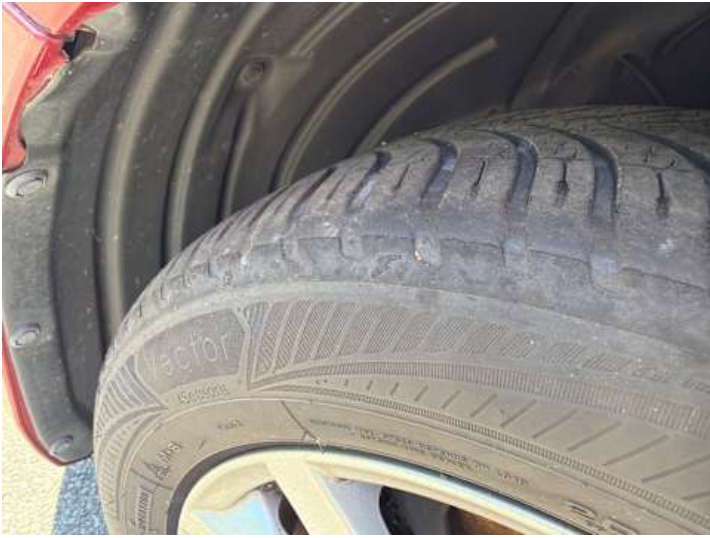
Rad (Ungleichmäßig abgefahren)
