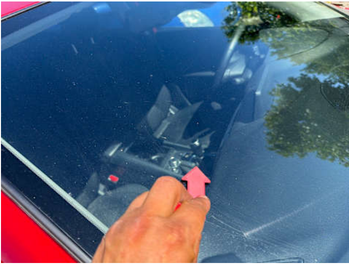
Windschutzscheibe (Steinschlag, Kratzer)
