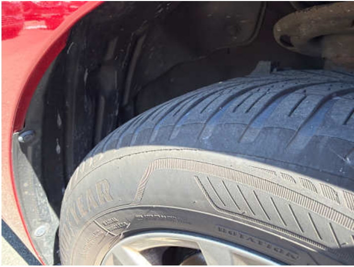
Rad (Ungleichmäßig abgefahren)
