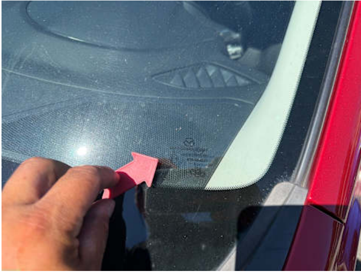
Windschutzscheibe (Steinschlag, Kratzer)
