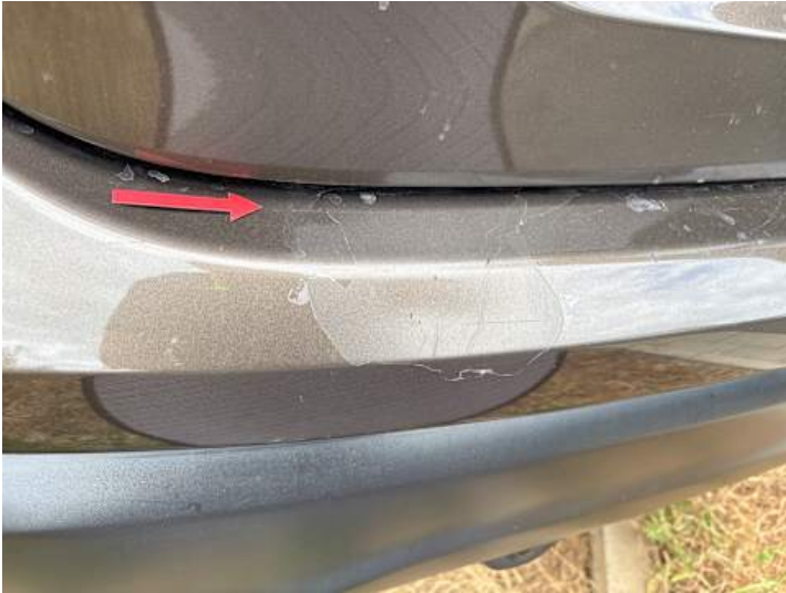
Stoßstange hinten (Lackschaden)
