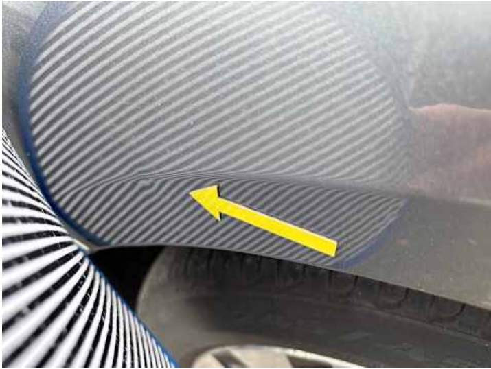
Seitenteil hinten rechts (Delle, Kratzer)
