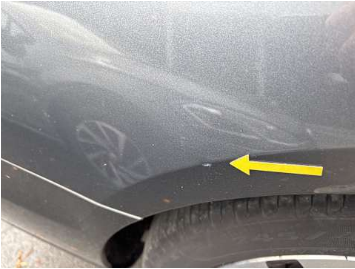
Seitenteil hinten rechts (Kratzer)
