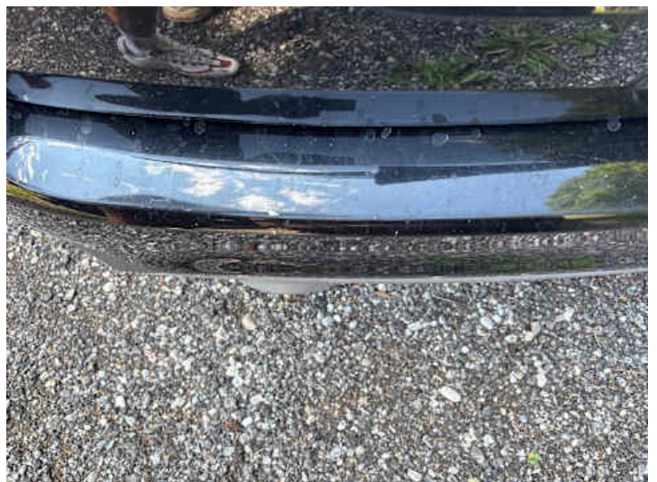
Stoßstange hinten (Kratzer, Lackschaden)
