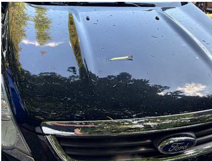
Motorhaube (Kratzer, Lackschaden, Rost)
