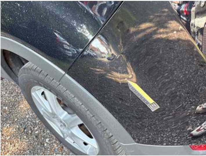
Stoßstange hinten (Kratzer, Lackschaden, Delle)
