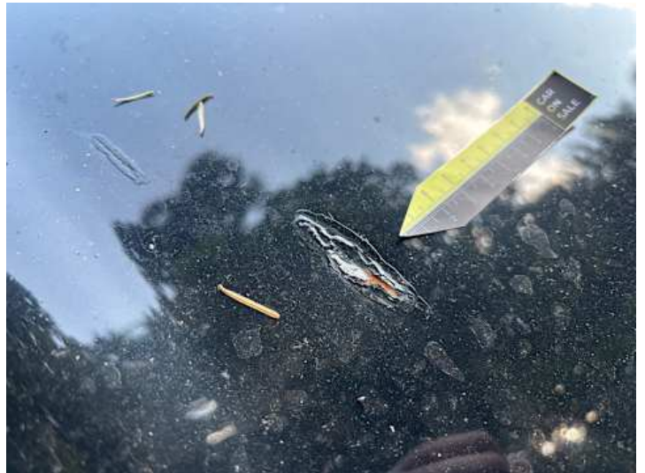
Motorhaube (Kratzer, Lackschaden, Rost)
