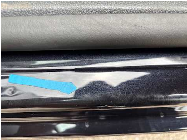
Schweller links (Delle, Kratzer)
