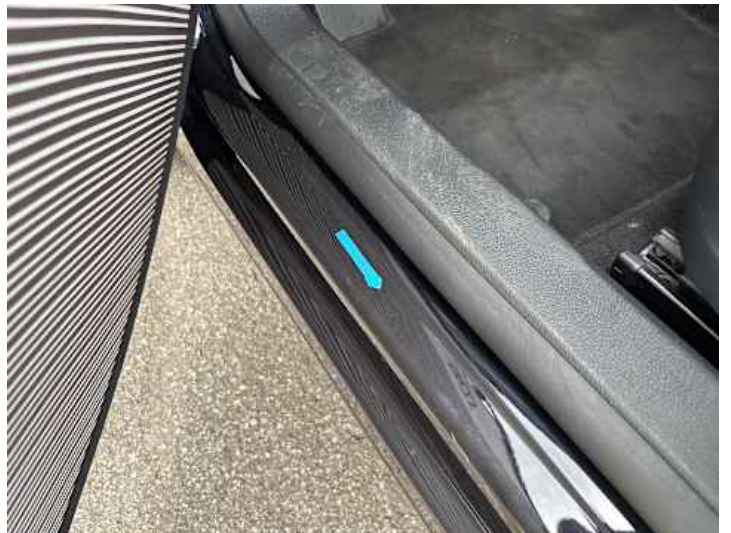
Schweller links (Delle, Kratzer)
