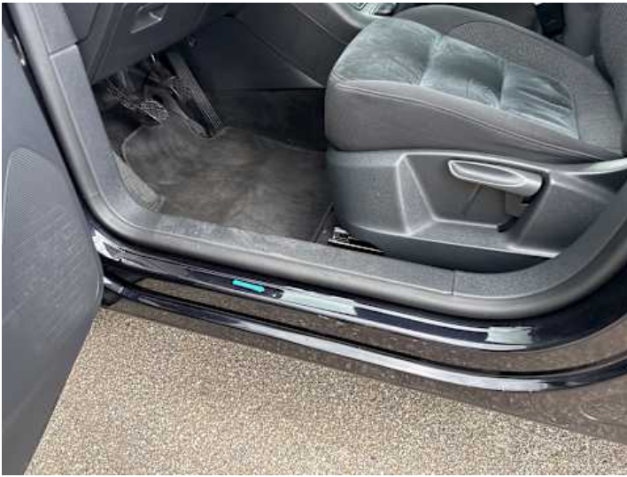
Schweller links (Delle, Kratzer)
