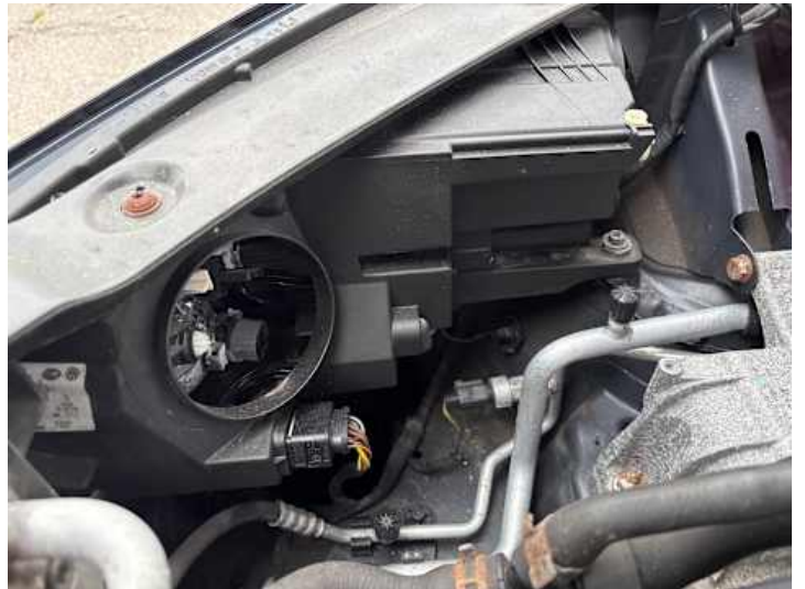
Scheinwerfer (rechts) (Anderer Schaden): Abdeckung fehlt
