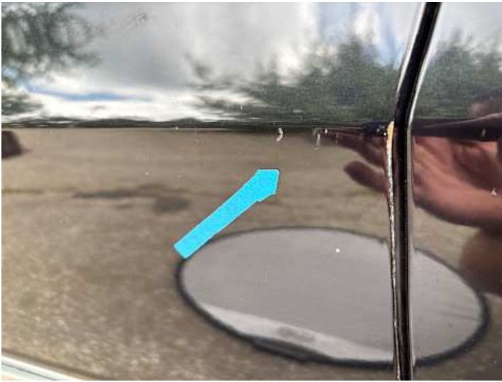
Fahrtür (Delle, Kratzer)
