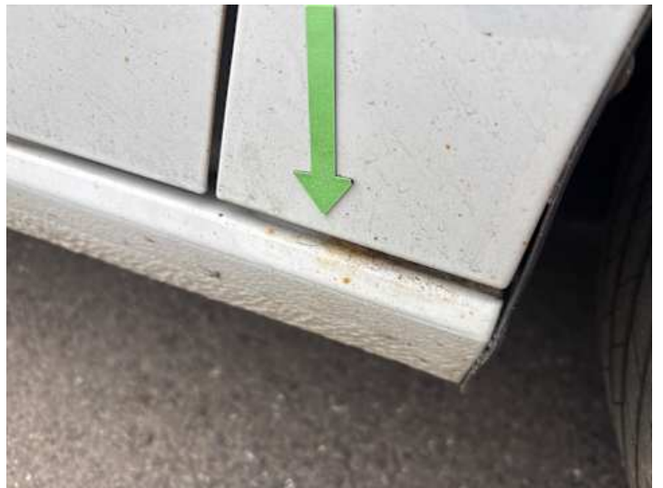
Schweller rechts (Rost)
