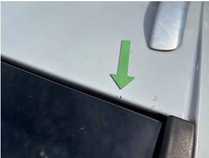
Dach (Rost, Lackschaden)
