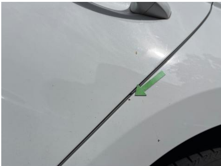
Seitenteil hinten links (Rost, Lackschaden)
