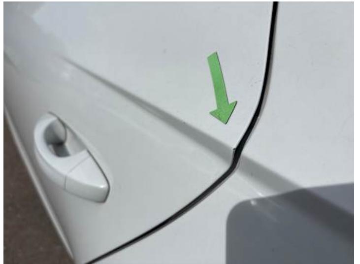
Türe hinten links (Lackschaden)
