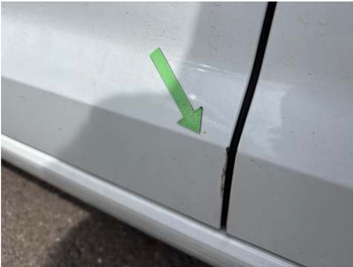
Fahrertür (Rost, Lackschaden)
