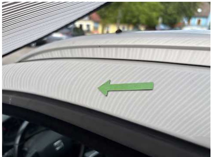
Seitenteil hinten links (Delle)
