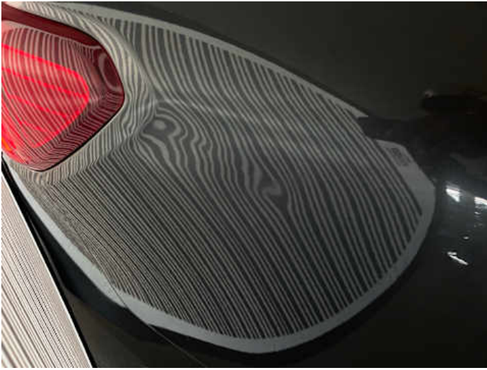
Seitenteil hinten rechts (Verformung)
