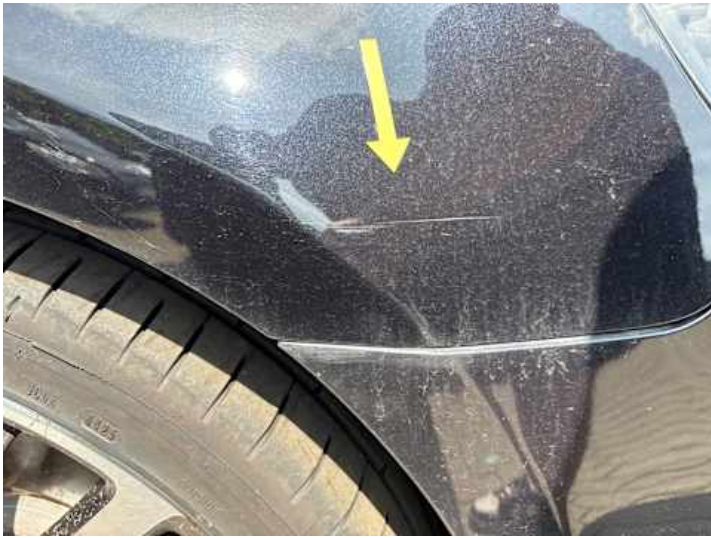
Kotflügel vorne rechts (Kratzer, Lackschaden)
