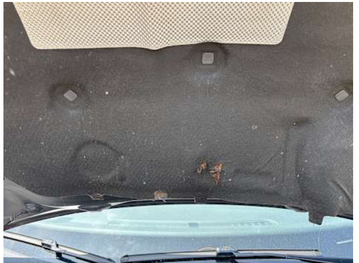
Motorhaube (Anderer Schaden): Marderspuren
