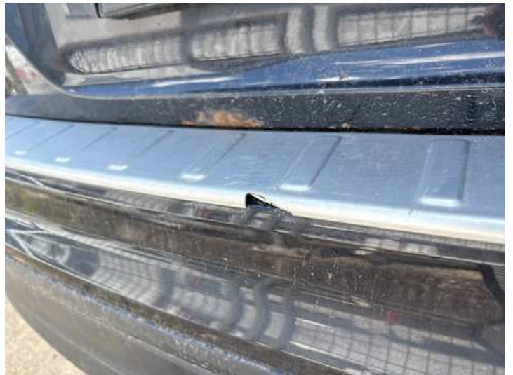
Stoßstange hinten (Riss/Bruch)
