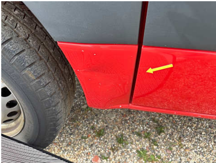
Seitenteil hinten rechts (Verformung)
