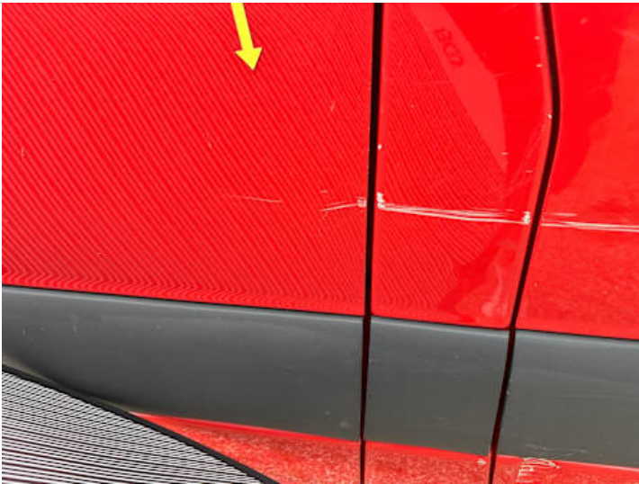
Türe hinten rechts (Kratzer, Verformung, Lackschaden)
