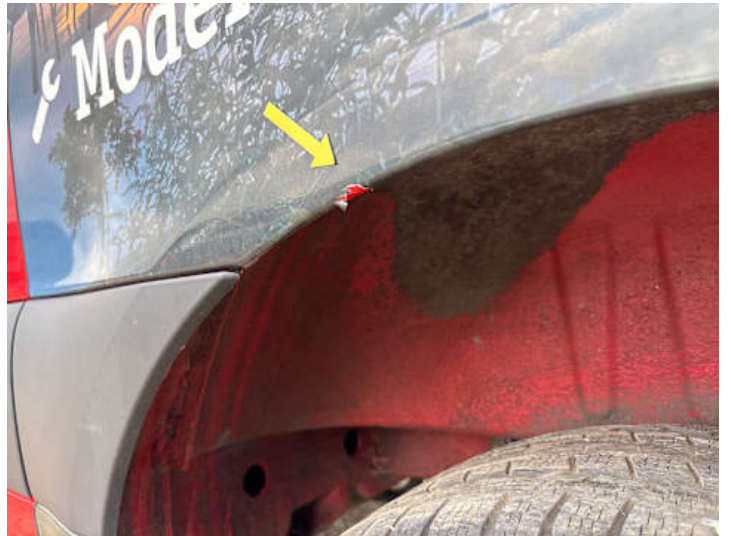
Seitenteil hinten links (Kratzer)
