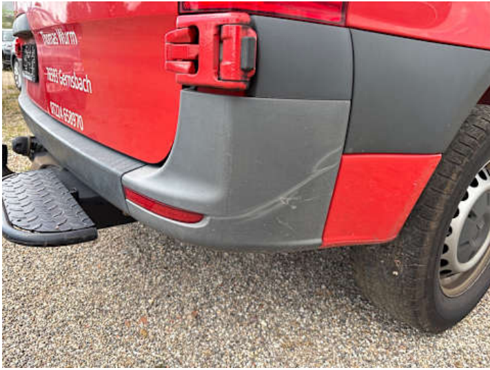
Stoßstange hinten (Delle, Kratzer, Ausgeblichen/Matt)
