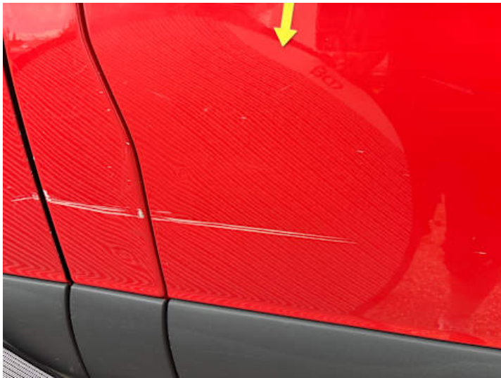
Beifahrtür (Verformung, Lackschaden)
