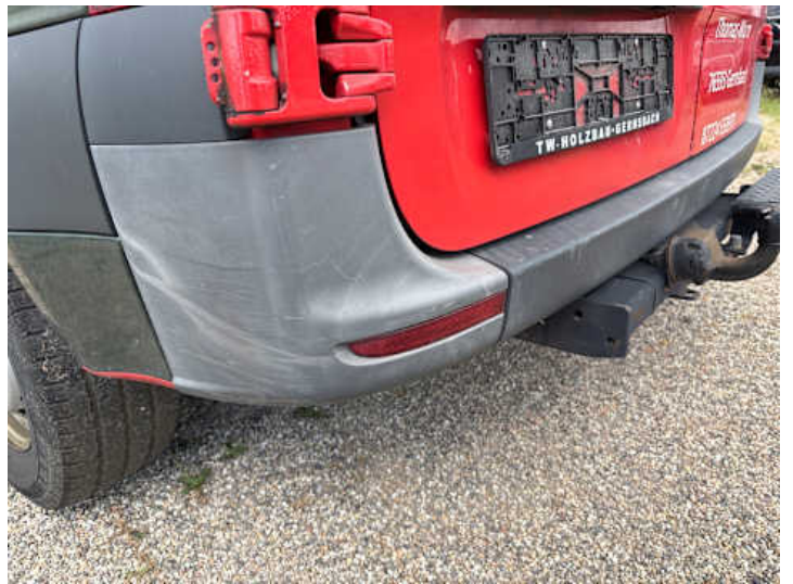
Stoßstange hinten (Delle, Kratzer, Ausgeblichen/Matt)
