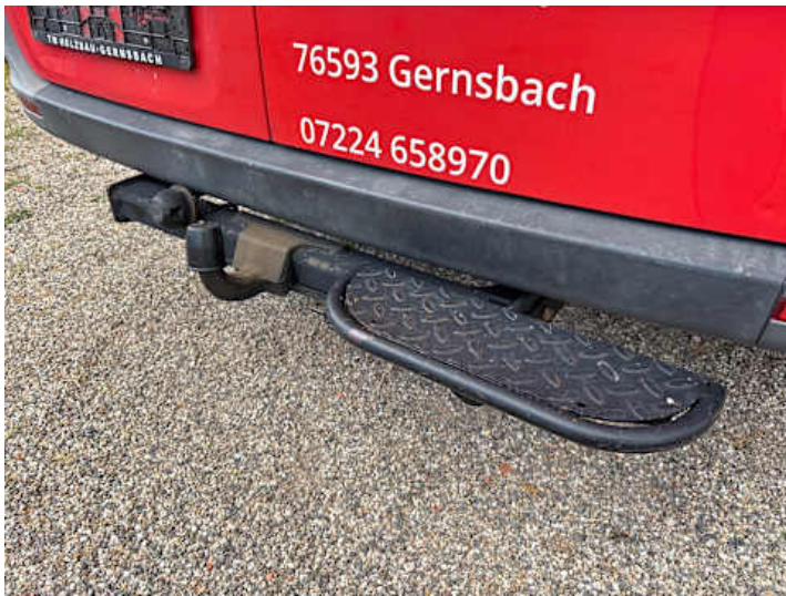
Stoßstange hinten (Delle, Kratzer, Ausgeblichen/Matt)
