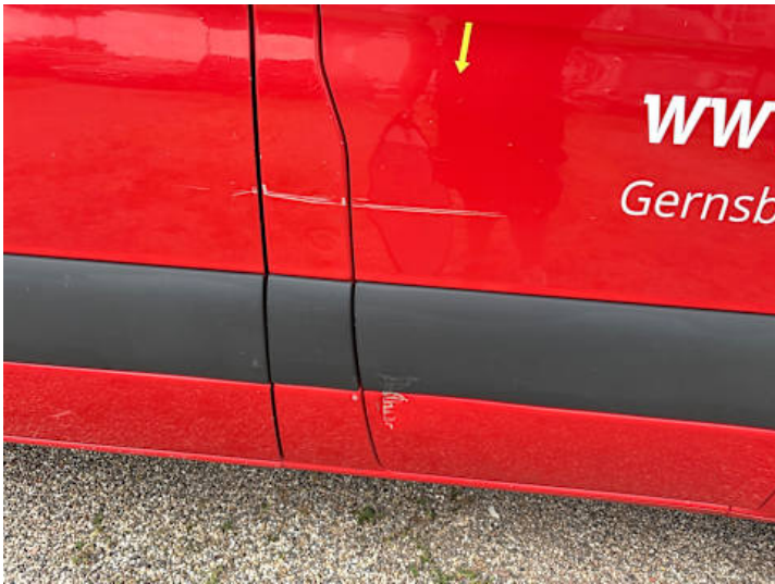
Beifahrtür (Verformung, Lackschaden)
