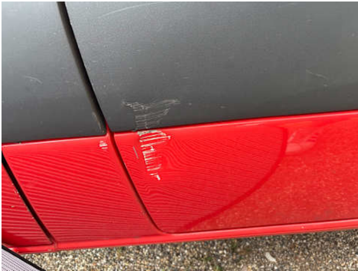
Beifahrtür (Verformung, Lackschaden)
