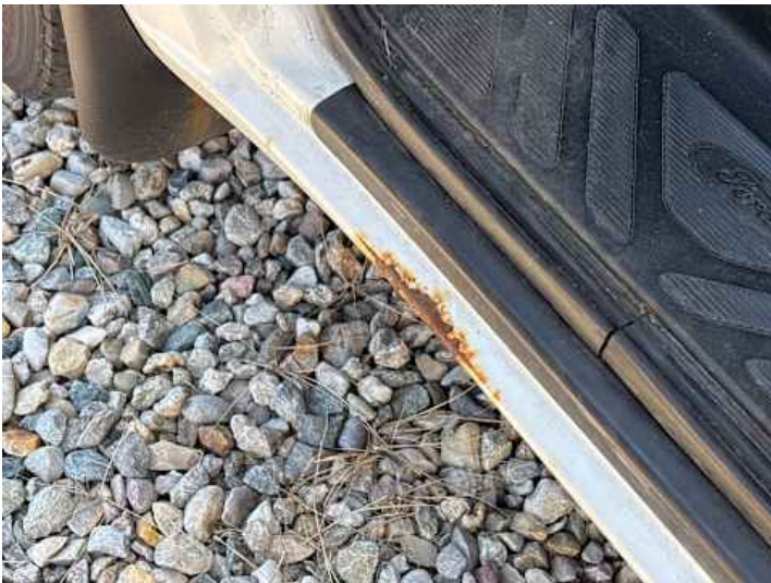
Schweller links (Rost)
