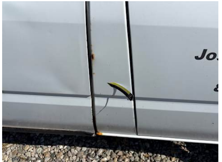
Schweller rechts (Rost)
