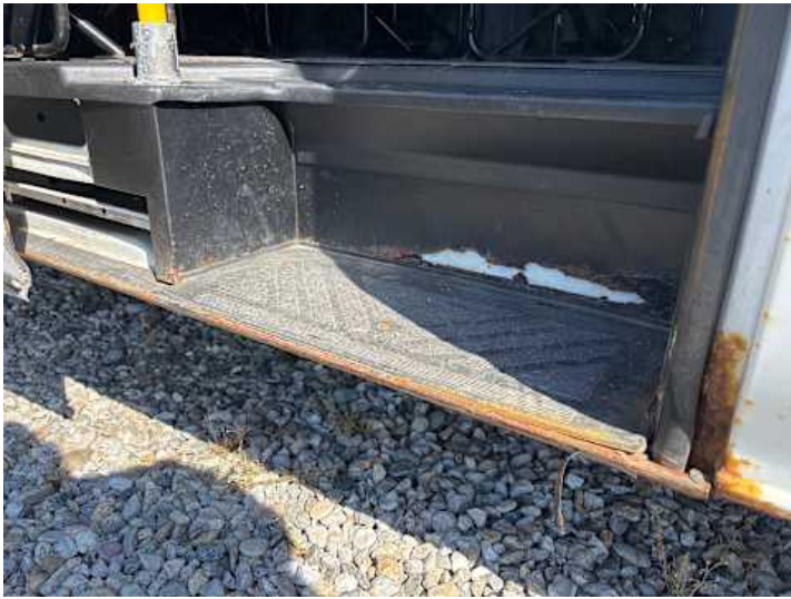
Schweller rechts (Rost)
