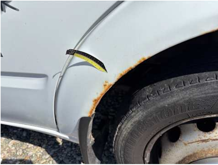
Kotflügel vorne rechts (Rost)
