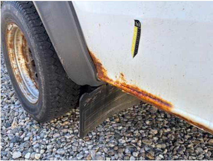
Seitenteil hinten links (Rost)
