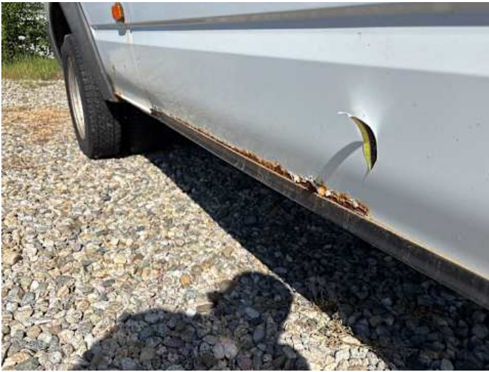
Türe hinten rechts (Rost)
