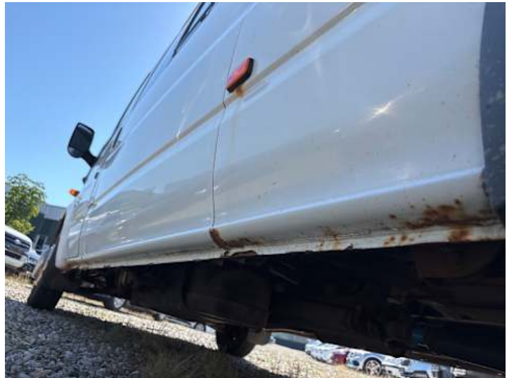
Schweller links (Rost)
