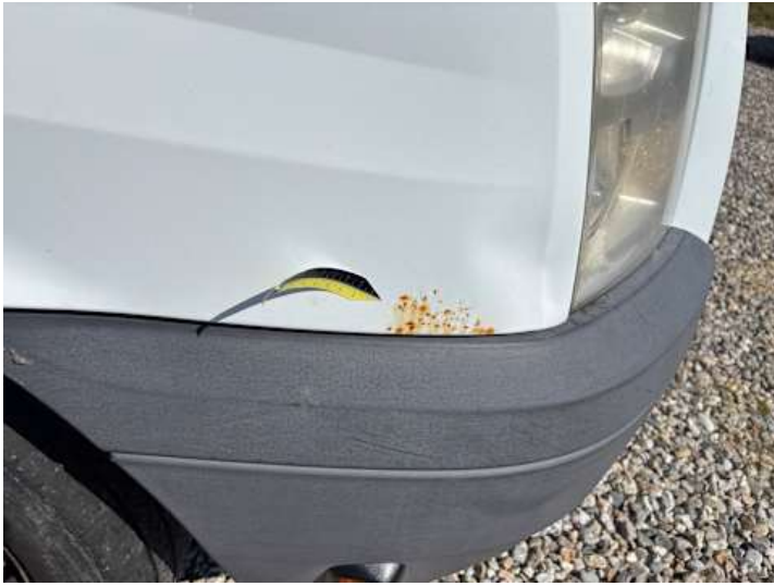
Kotflügel vorne rechts (Rost)
