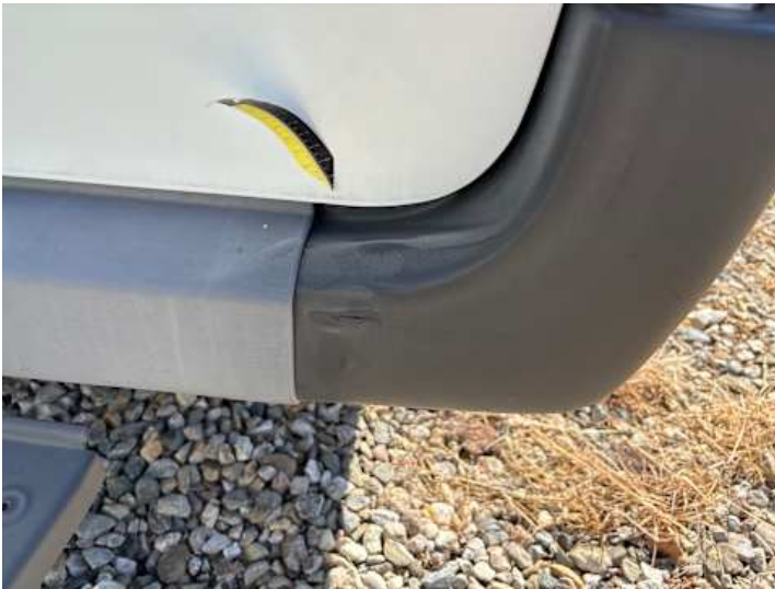
Stoßstange hinten (Verformung)
