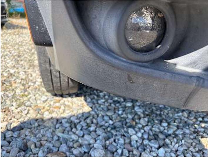
Stoßstange vorne (Kratzer)
