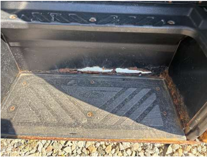
Schweller rechts (Rost)
