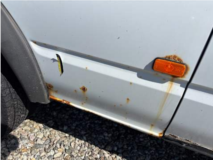
Seitenteil hinten rechts (Rost)
