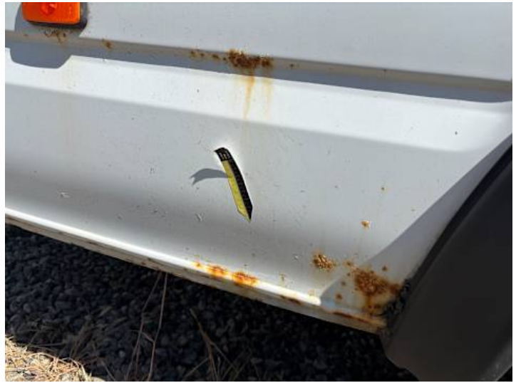
Seitenteil hinten rechts (Rost)
