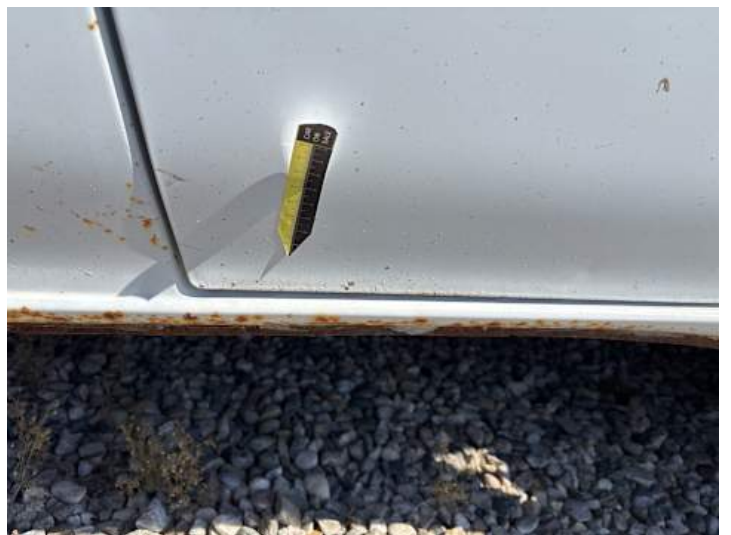
Beifahrertür (Steinschlag, Rost)
