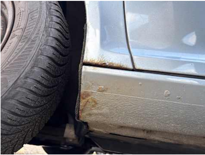
Schweller links (Rost)
