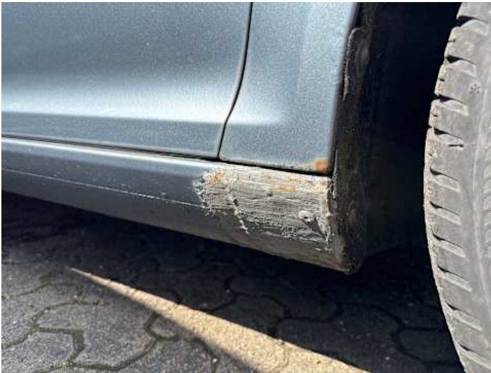
Schweller rechts (Unsachgemäß instand gesetzt)
