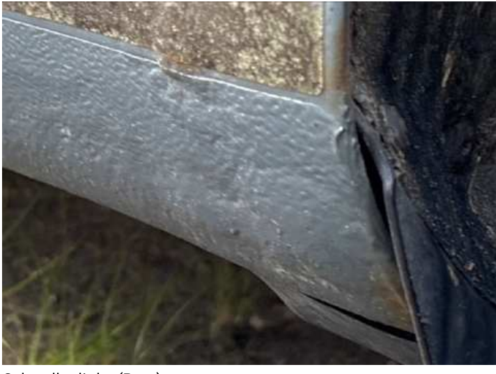
Schweller links (Rost)
