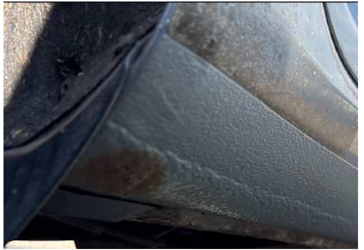
Schweller rechts (Rost)
