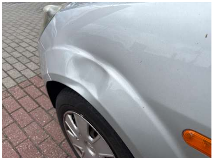
Kotflügel vorne links (Verformung)
