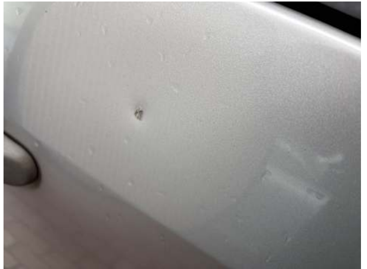
Beifahrertür (Delle, Kratzer)
