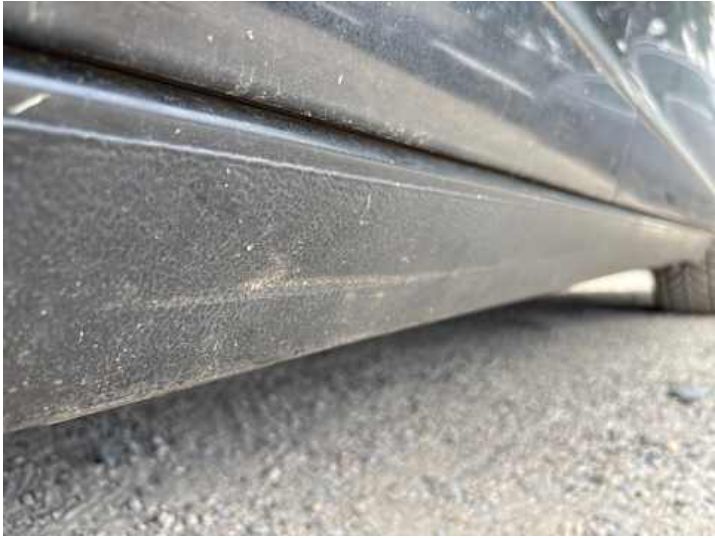
Schweller rechts (Kratzer)
