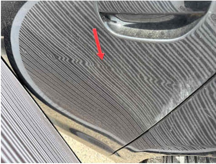
Türe hinten links (Delle)
