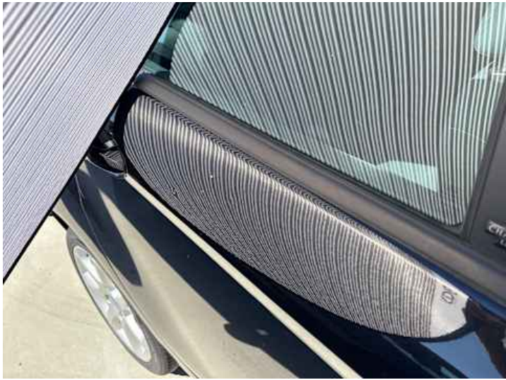
Türe hinten rechts (Delle)
