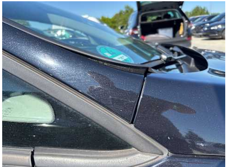
Windschutzscheibe (Anderer Schaden): Dichtung defekt
