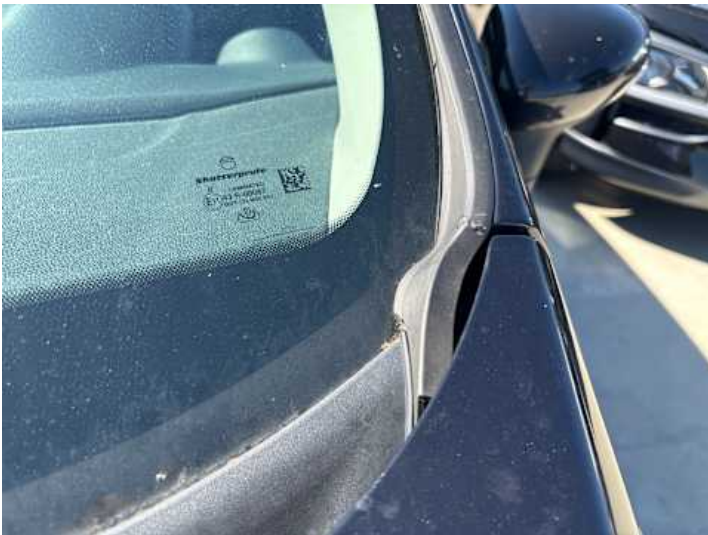
Windschutzscheibe (Anderer Schaden): Dichtung defekt
