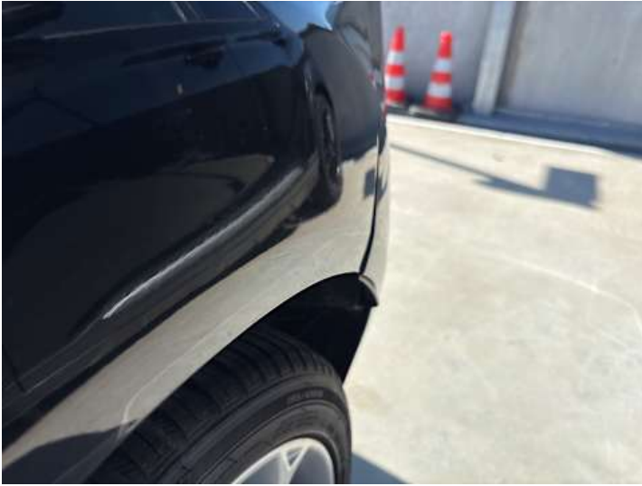
Stoßstange hinten (Spaltmaße ungenau)
