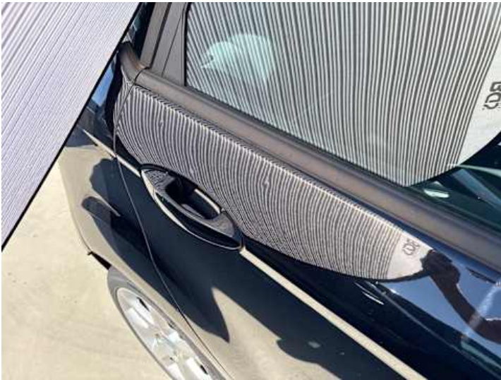
Türe hinten rechts (Delle)
