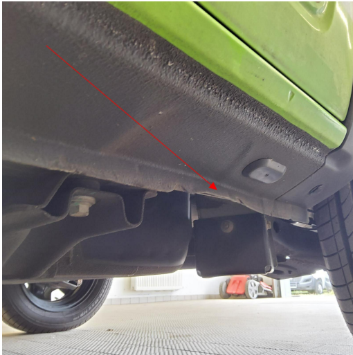
Bild 5: Außen, Seitenschweller links - Aufnahme, leicht verformt, smart repair
