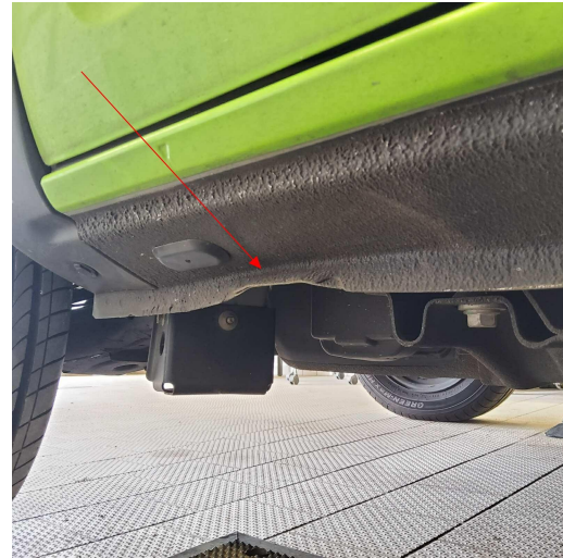
Bild 6: Außen, Seitenschweller rechts - Aufnahme, leicht verformt, smart repair
