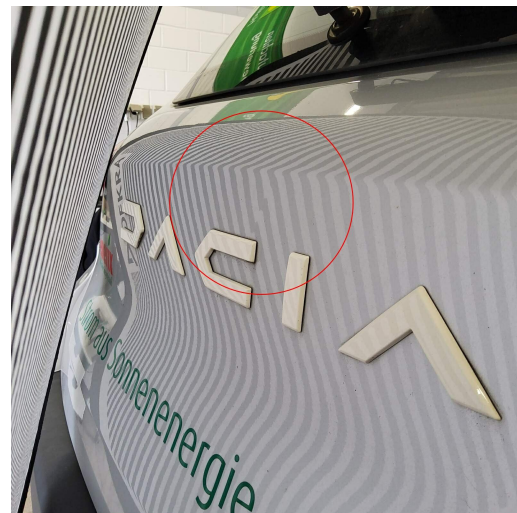
Bild 4: Außen, Heckdeckel, eingedellt, drücken
