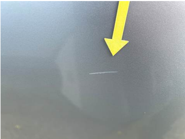
Türe hinten links (Lackschaden)
