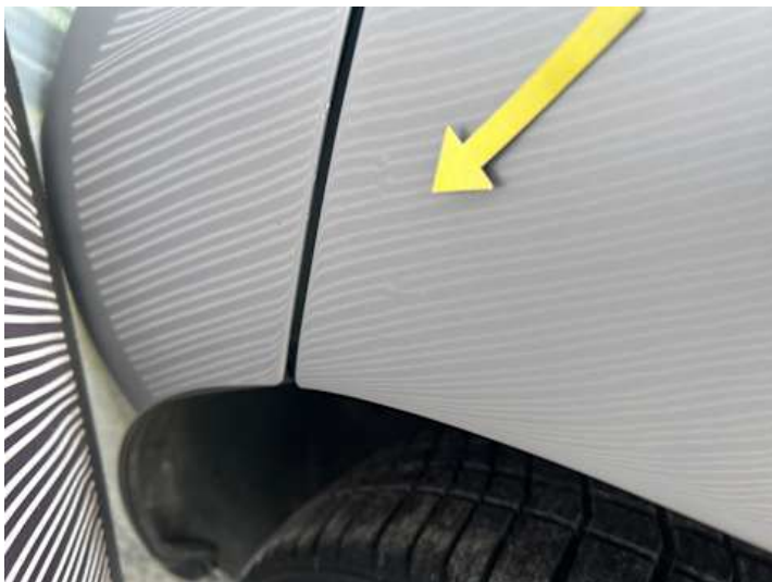
Seitenteil hinten links (Verformung)
