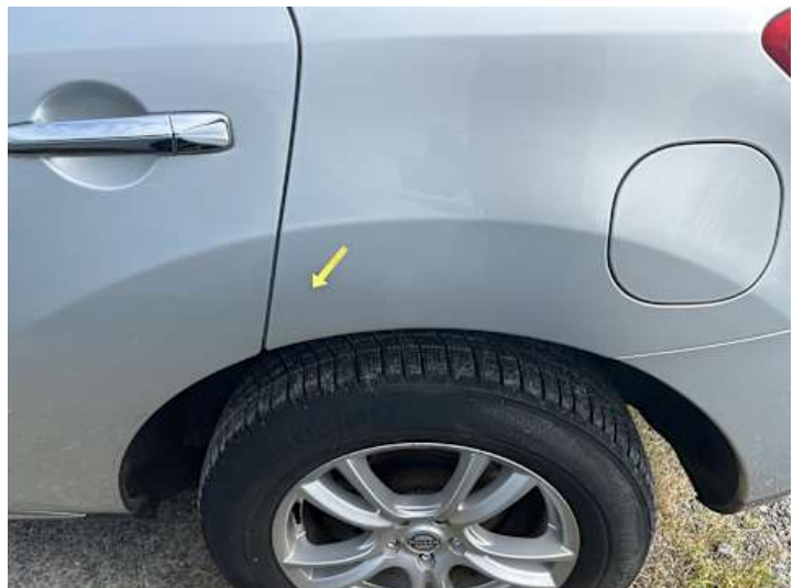
Seitenteil hinten links (Verformung)
