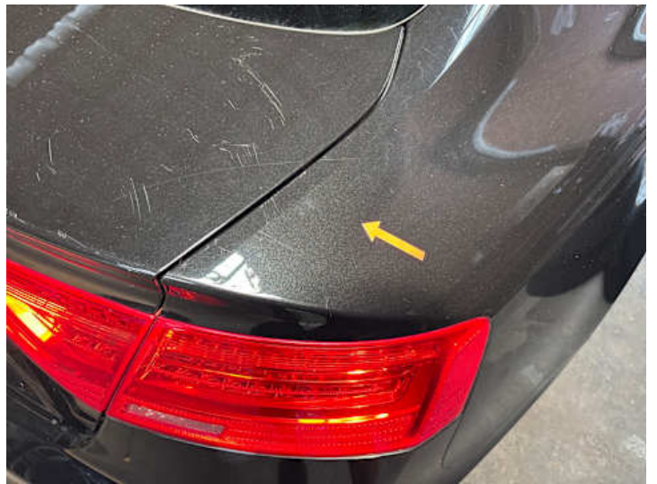
Seitenteil hinten rechts (Kratzer)
