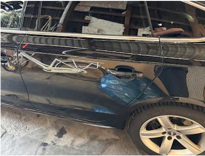
Türe hinten links (Delle)
