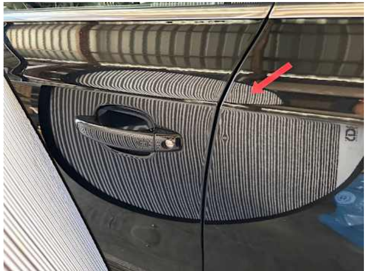
Türe hinten links (Delle)
