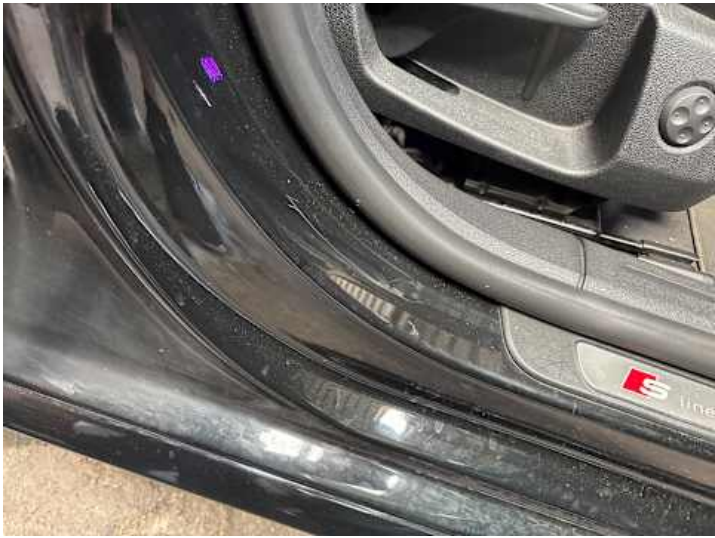
Schweller rechts (Kratzer)
