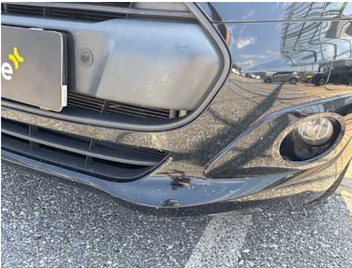
Stoßstange vorne (Kratzer, Steinschlag)
