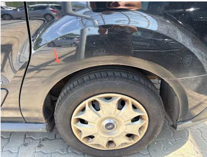
Seitenteil hinten links (Rost, Ausgeblichen/Matt, Unsachgemäß instand gesetzt)
