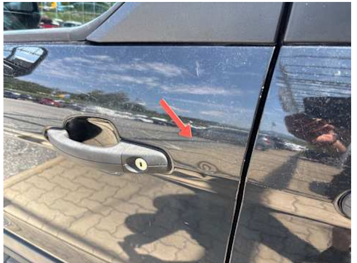
Fahrtür (Delle, Kratzer)
