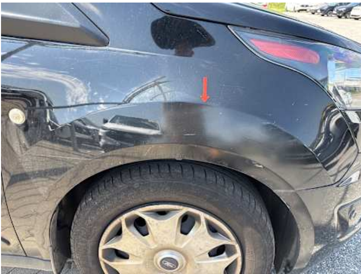
Kotflügel vorne rechts (Ausgeblichen/Matt)
