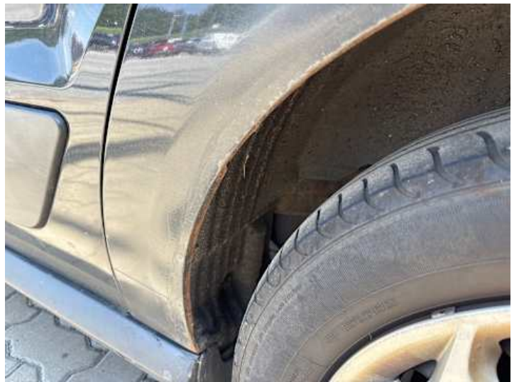
Seitenteil hinten links (Rost, Ausgeblichen/Matt, Unsachgemäß instand gesetzt)
