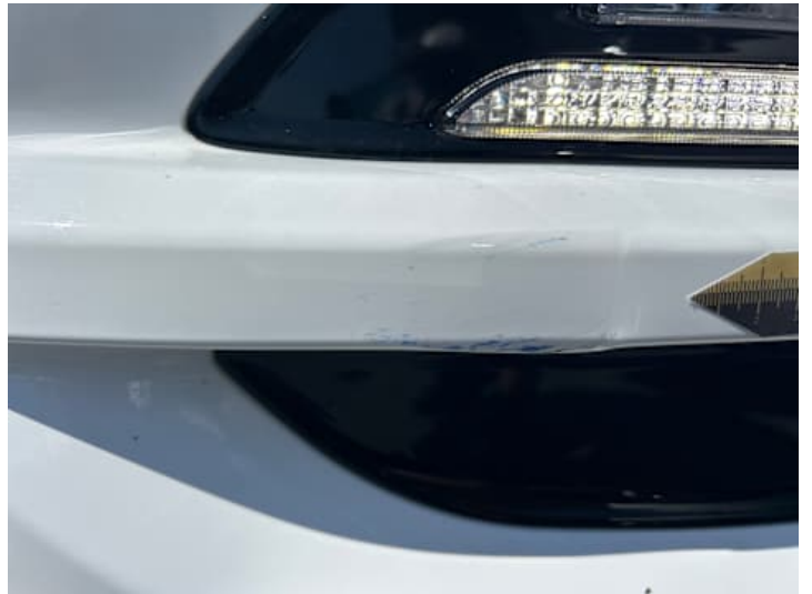
Stoßstange vorne (Delle, Lackschaden)
