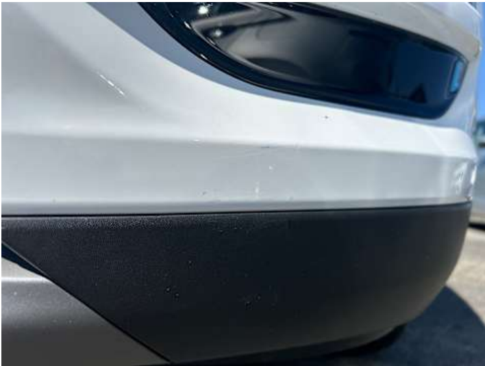
Stoßstange vorne (Delle, Lackschaden)
