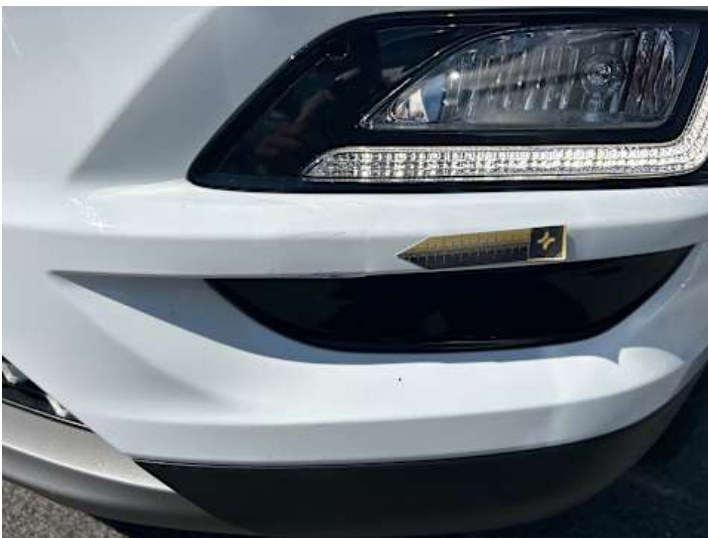
Stoßstange vorne (Delle, Lackschaden)
