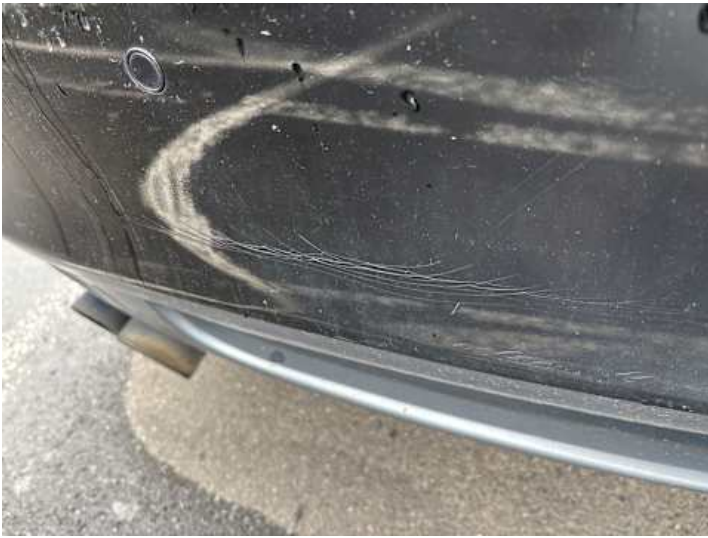
Stoßstange hinten (Lackschaden, Riss/Bruch)
