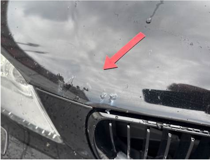
Motorhaube (Lackschaden, Rost)
