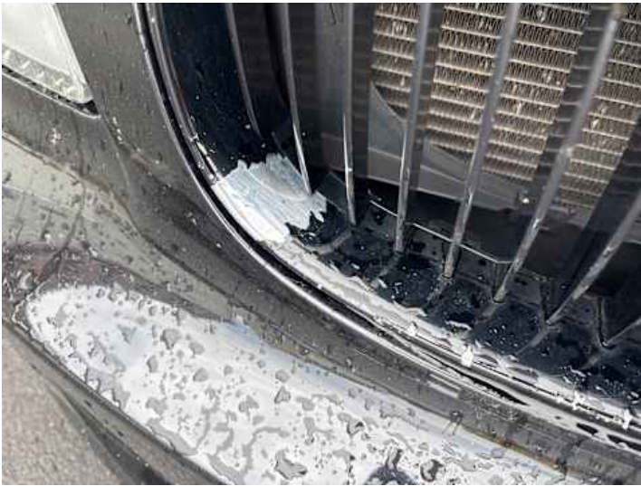
Stoßstange vorne (Anderer Schaden): Beschichtung löst sich
