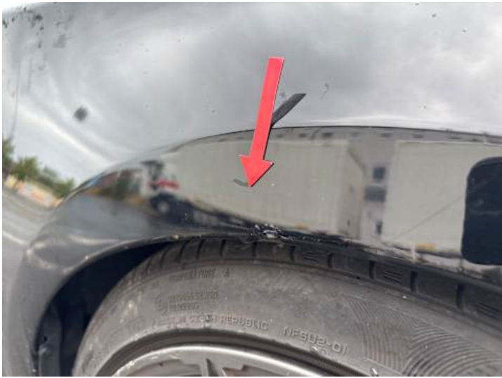
Kotflügel vorne rechts (Rost, Lackschaden)
