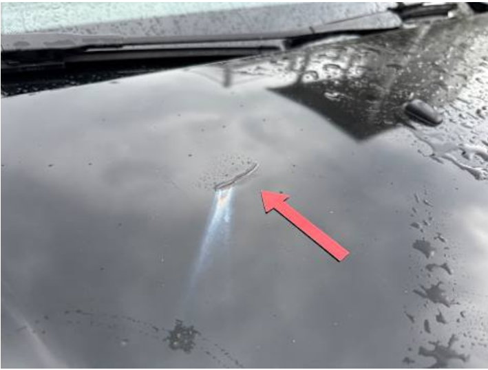
Motorhaube (Lackschaden, Rost)
