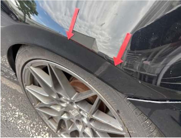
Seitenteil hinten links (Verformung)
