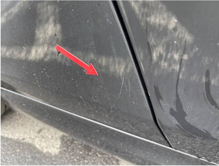
Seitenteil hinten rechts (Kratzer)
