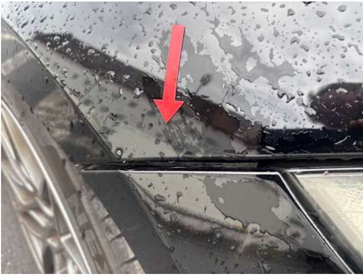
Kotflügel vorne rechts (Spaltmaße ungenau)
