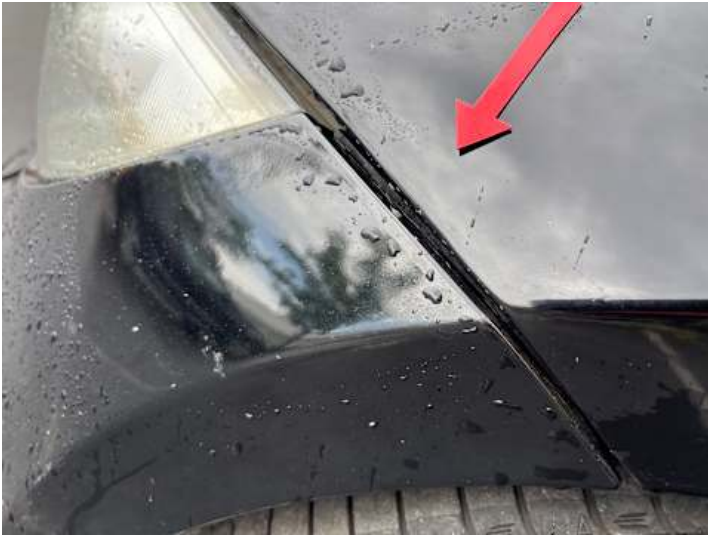
Kotflügel vorne links (Spaltmaße ungenau)
