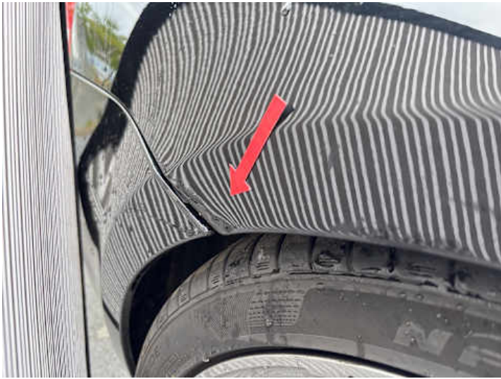
Seitenteil hinten rechts (Verformung)
