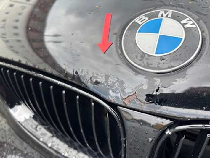
Motorhaube (Lackschaden, Rost)
