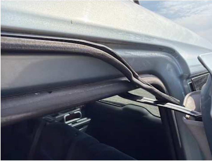
Türe hinten links (Anderer Schaden, Delle): Dichtung abgeklebt
