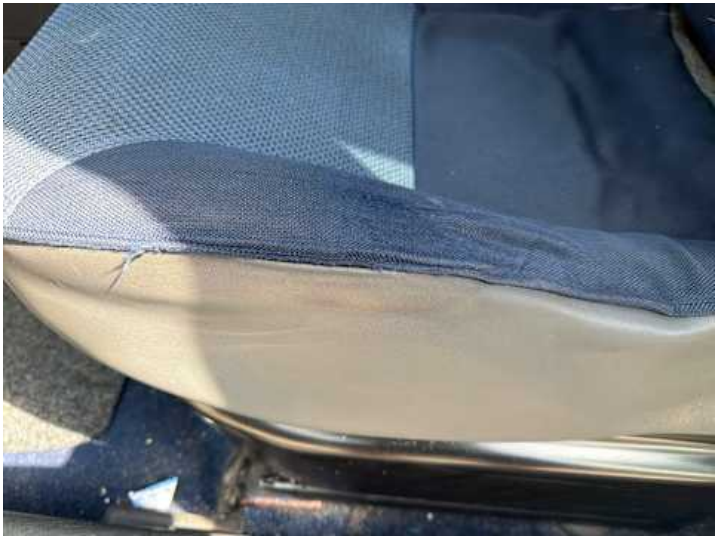
Innenraum (Riss/Bruch, Verschmutzung, Verschleiß, Kratzer)
