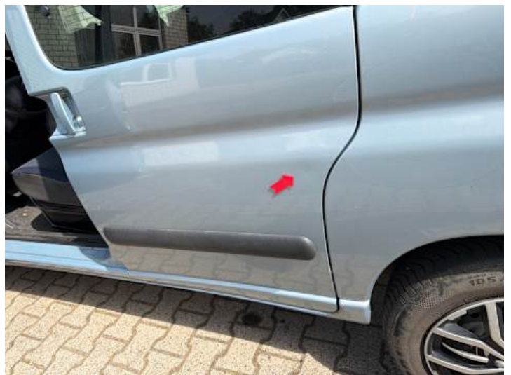
Türe hinten links (Anderer Schaden, Delle): Dichtung abgeklebt
