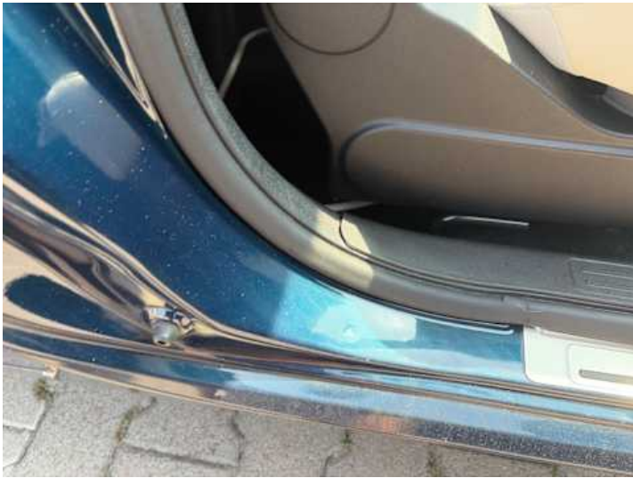
Schweller rechts (Kratzer, Delle, Lackschaden)
