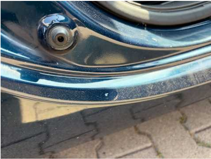
Schweller rechts (Kratzer, Delle, Lackschaden)
