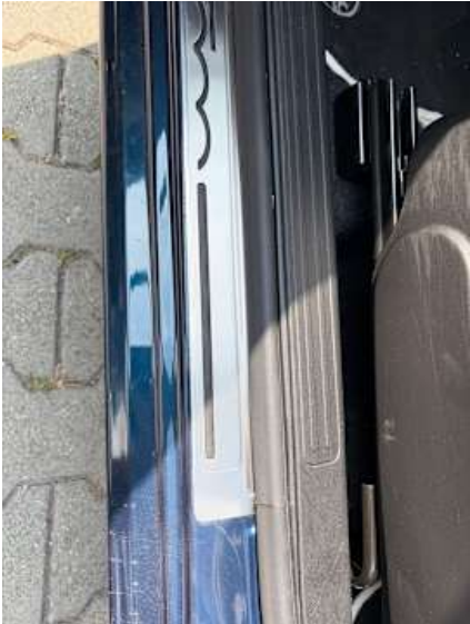
Schweller links (Delle, Kratzer, Lackschaden)
