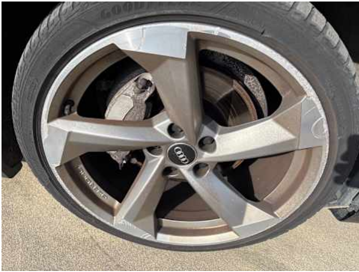
Rad (Kerben, Kratzer, Riss/Bruch)
