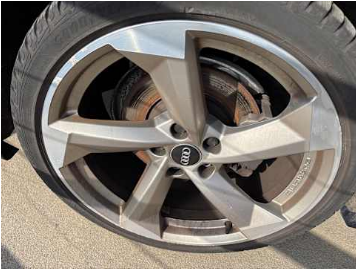
Rad (Kerben, Kratzer, Riss/Bruch)
