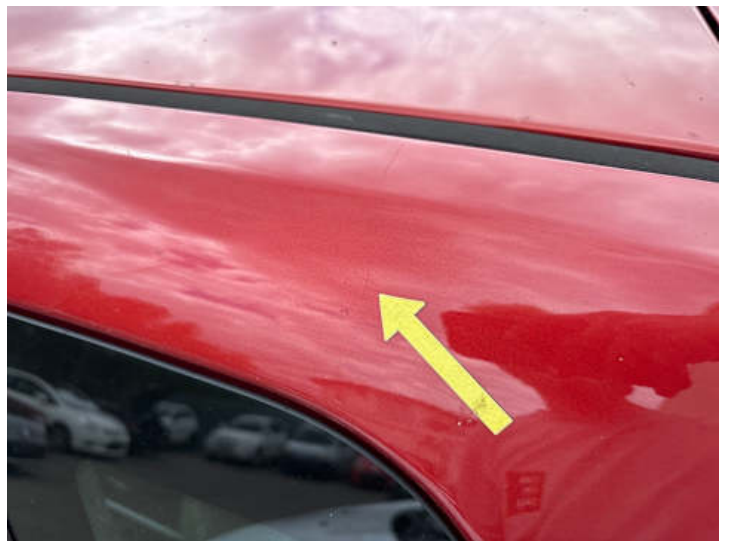
Türe hinten links (Delle, Kratzer)
