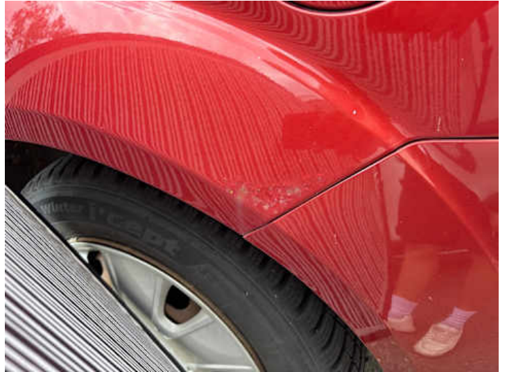
Seitenteil hinten links (Rost)
