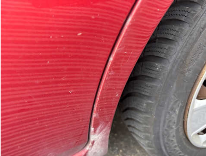
Seitenteil hinten links (Rost)
