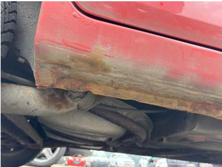
Seitenteil hinten rechts (Rost)
