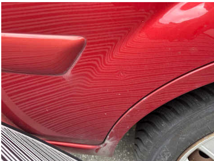
Türe hinten links (Delle, Kratzer)
