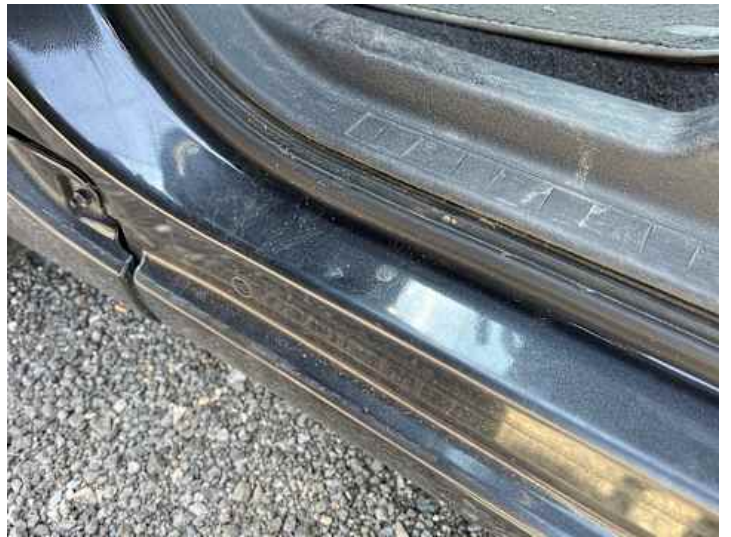
Schweller links (Kratzer, Delle)
