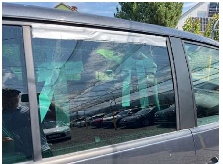
Türe hinten rechts (Riss/Bruch)
