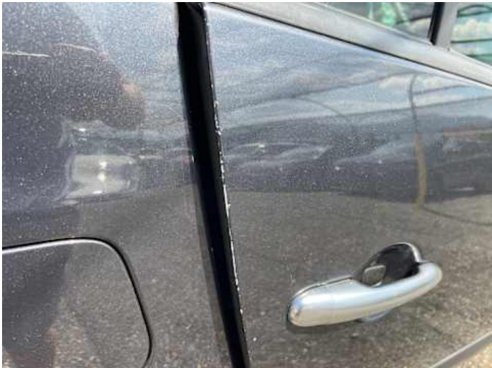
Türe hinten rechts (Lackschaden)
