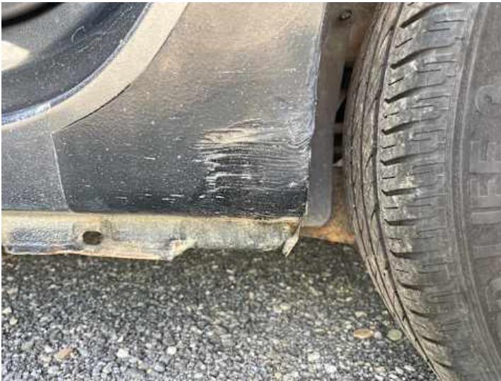
Schweller links (Unsachgemäß instand gesetzt, Rost)
