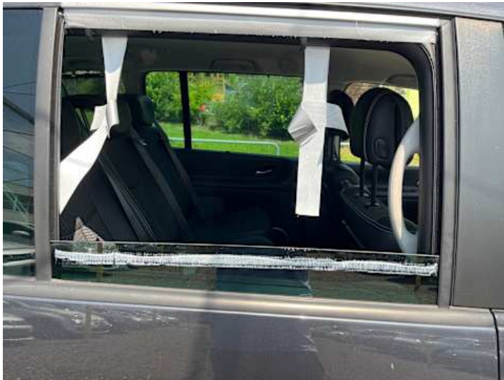
Türe hinten rechts (Riss/Bruch)
