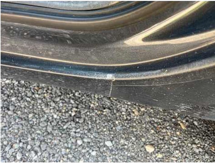
Schweller links (Lackschaden)
