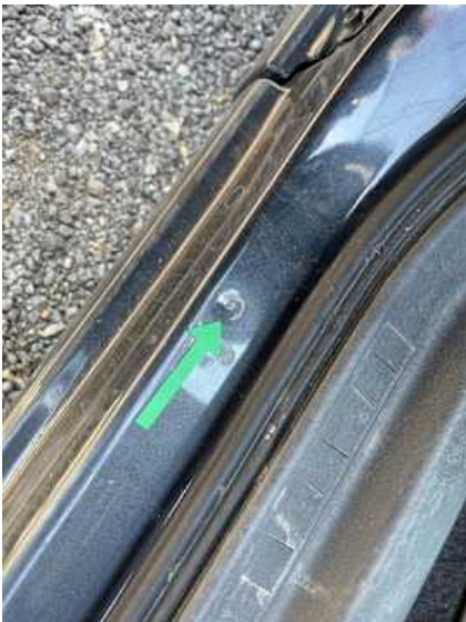
Schweller links (Kratzer, Delle)
