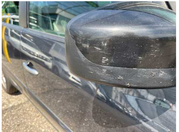
Beifahrertür (Lackschaden, Kratzer)
