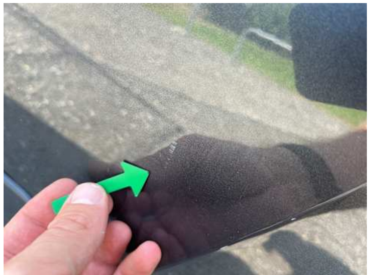
Türe hinten links (Lackschaden)
