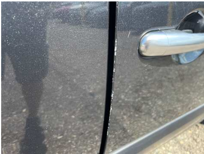
Beifahrertür (Lackschaden, Kratzer)
