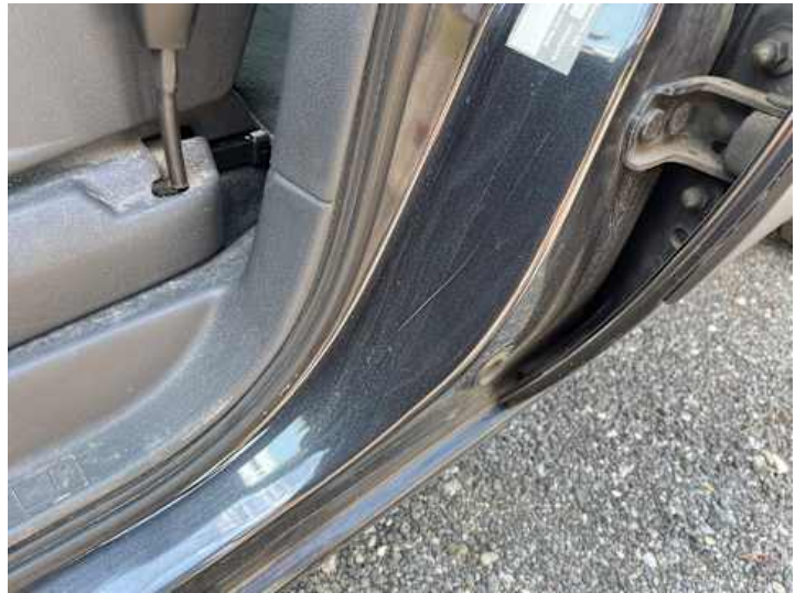
Schweller links (Kratzer, Delle)
