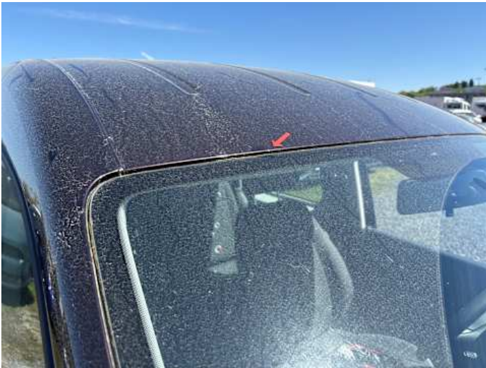
Dach (Steinschlag, Rost)
