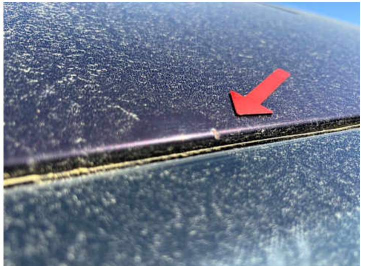
Dach (Steinschlag, Rost)
