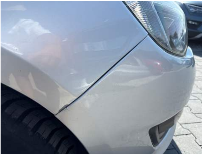
Stoßstange vorne (Lackschaden, Spaltmaße ungenau)
