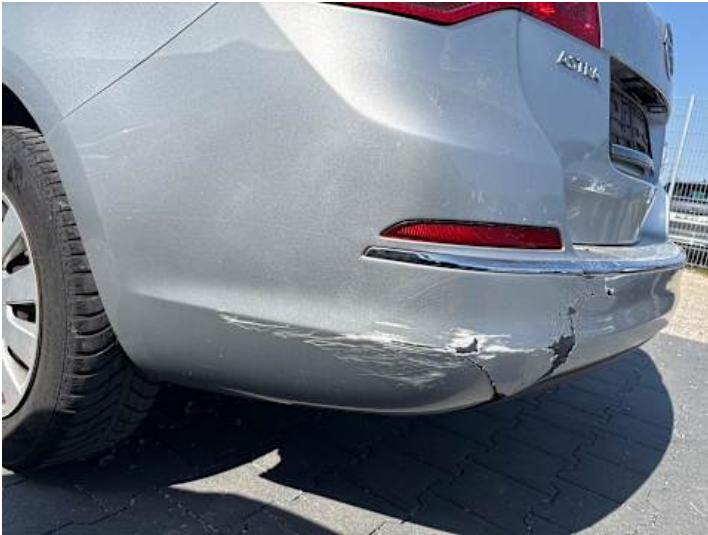
Stoßstange hinten (Lackschaden, Riss/Bruch)
