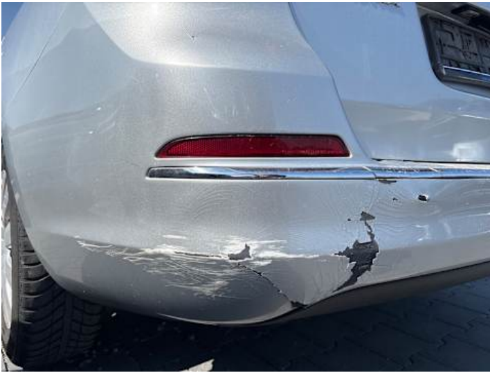
Stoßstange hinten (Lackschaden, Riss/Bruch)
