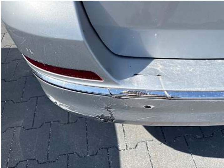
Stoßstange hinten (Lackschaden, Riss/Bruch)
