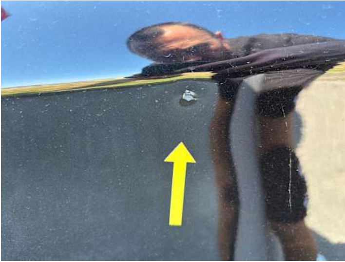
Türe hinten links (Delle, Kratzer)
