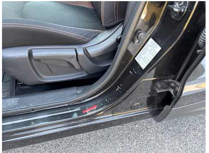
Schweller links (Delle, Kratzer)
