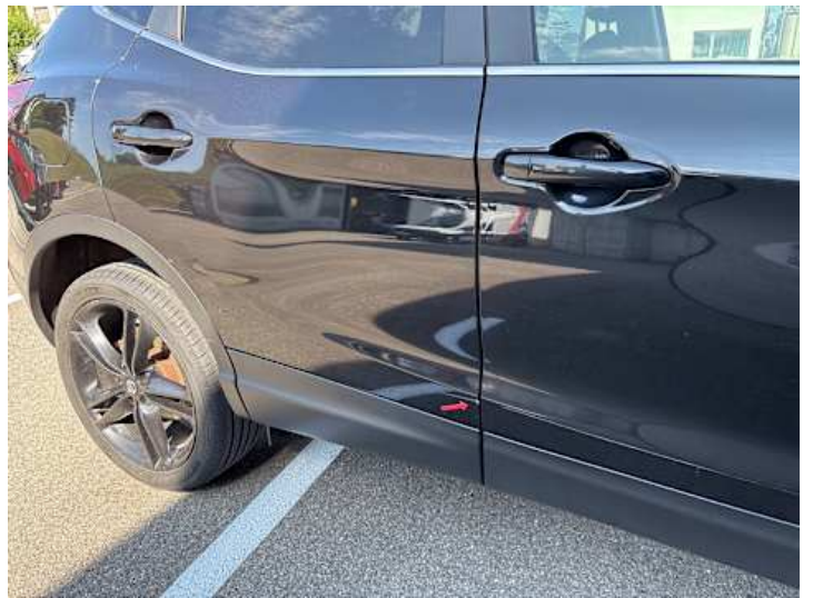
Türe hinten rechts (Delle, Kratzer)
