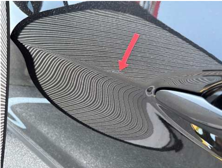
Fahrtür (Delle, Kratzer)
