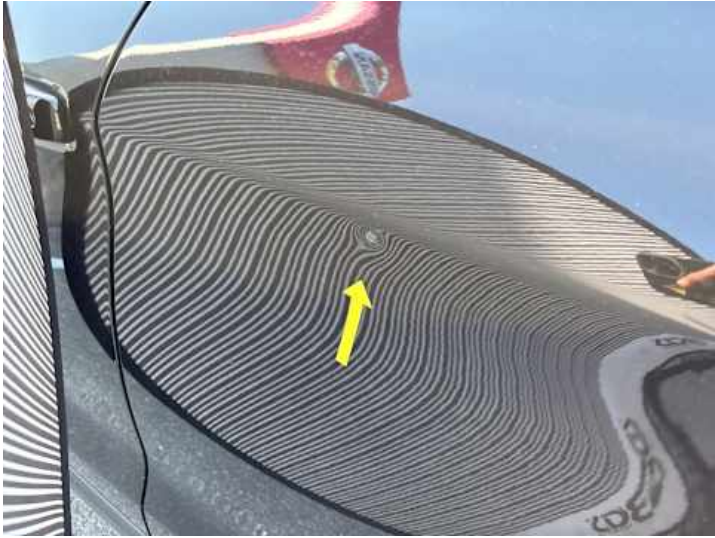
Türe hinten links (Delle, Kratzer)
