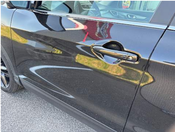
Fahrtür (Delle, Kratzer)
