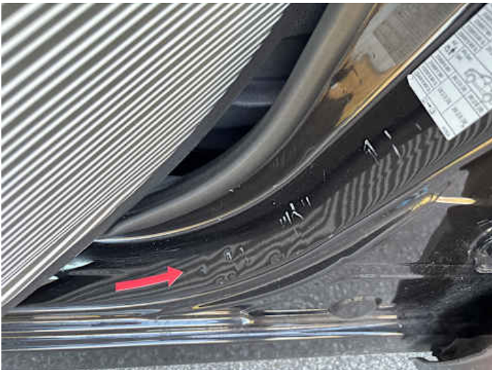
Schweller links (Delle, Kratzer)
