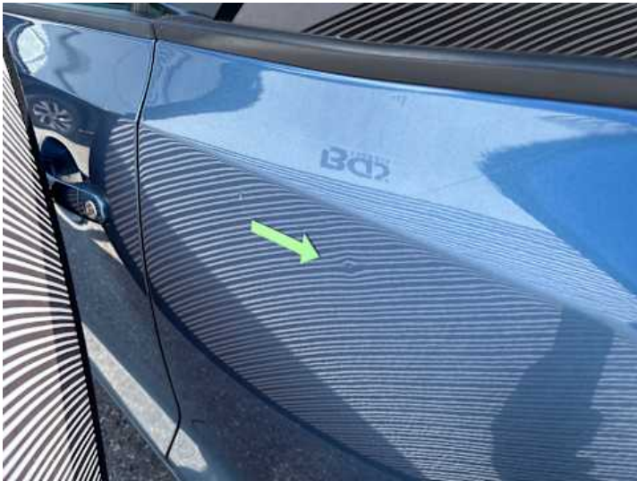
Seitenteil hinten links (Delle, Kratzer)
