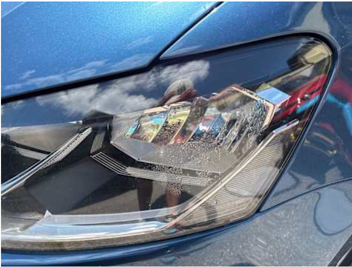
Scheinwerfer (links) (Undicht)
