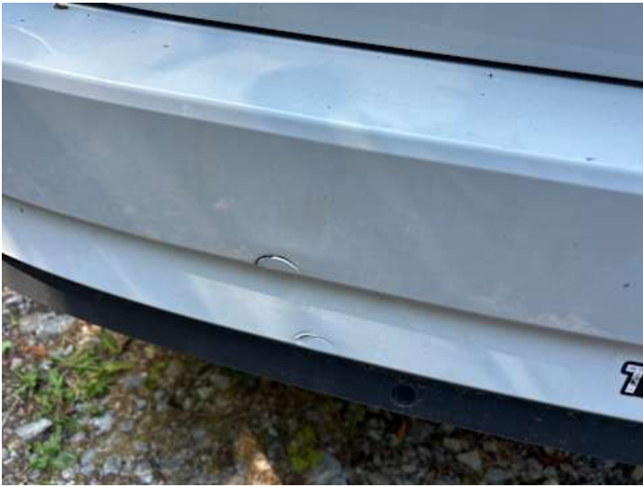
Stoßstange hinten (Riss/Bruch)
