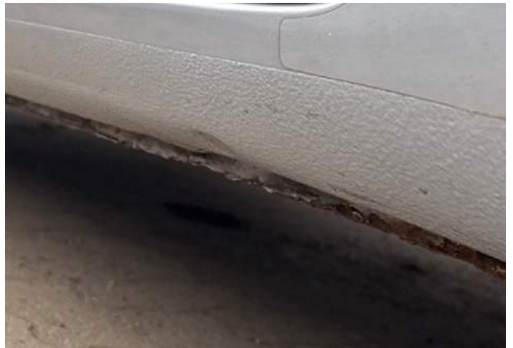
Schweller links (Verformung)
