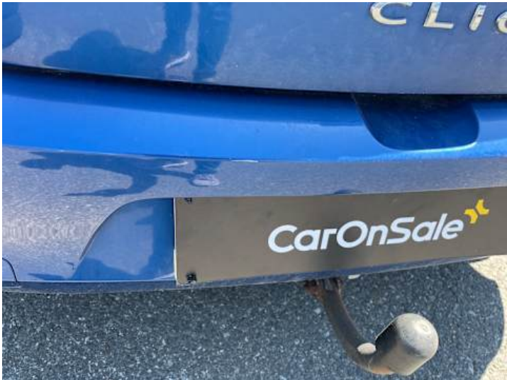
Stoßstange hinten (Delle, Kratzer, Spaltmaße ungenau)
