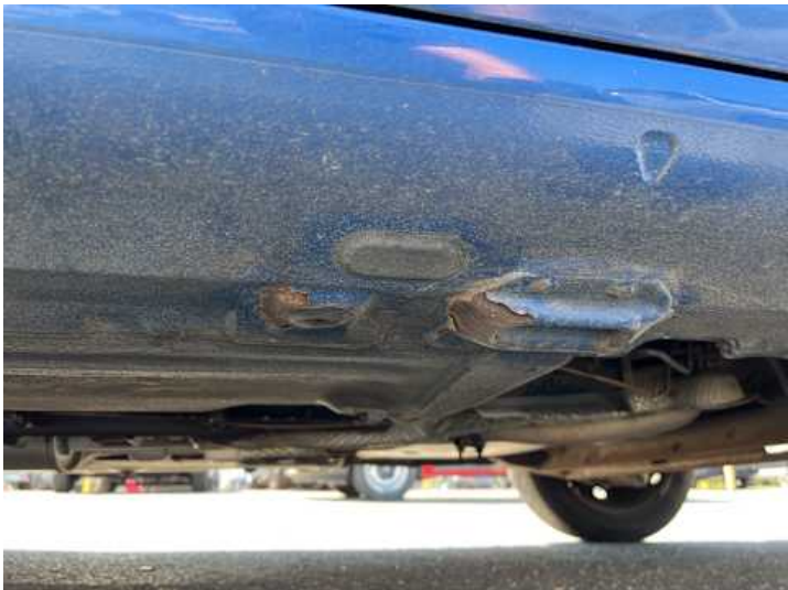
Schweller links (Rost, Lackschaden)
