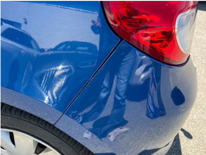
Stoßstange hinten (Delle, Kratzer, Spaltmaße ungenau)
