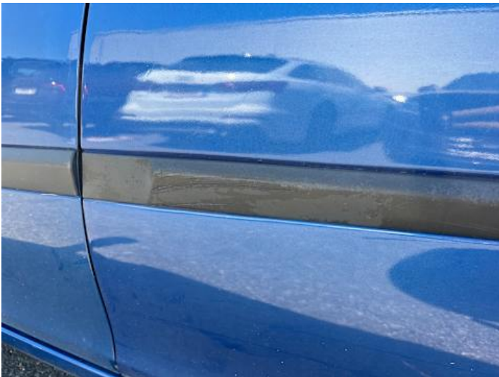
Türe hinten links (Kratzer)
