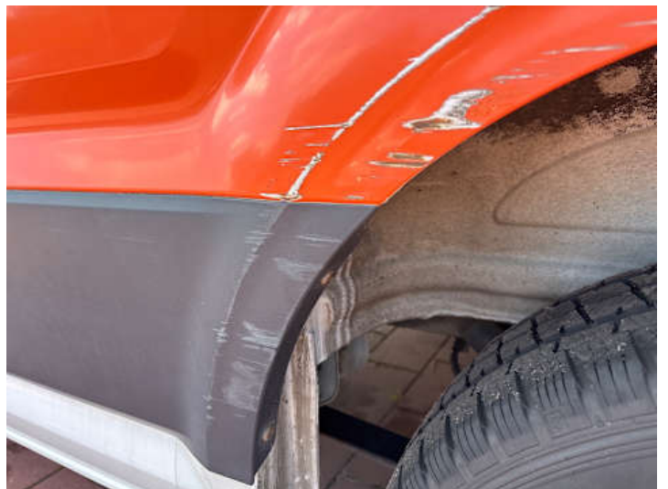
Seitenteil hinten links (Verformung)
