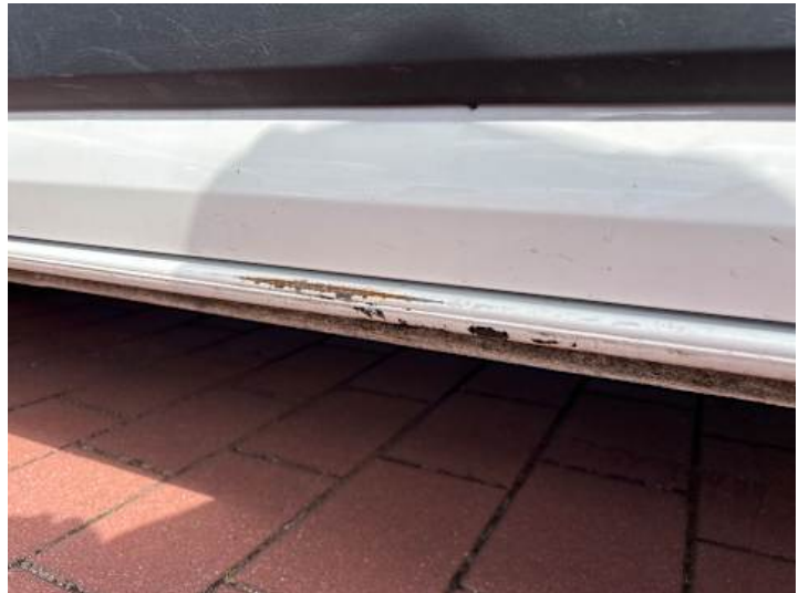
Schweller links (Rost)
