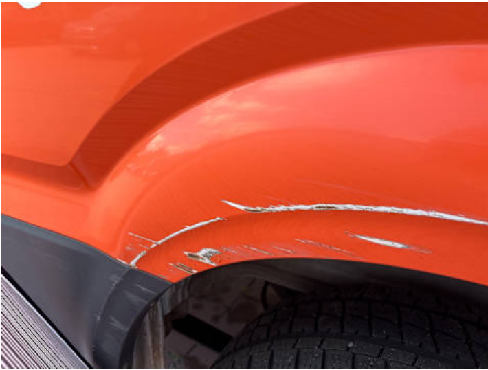
Seitenteil hinten links (Verformung)
