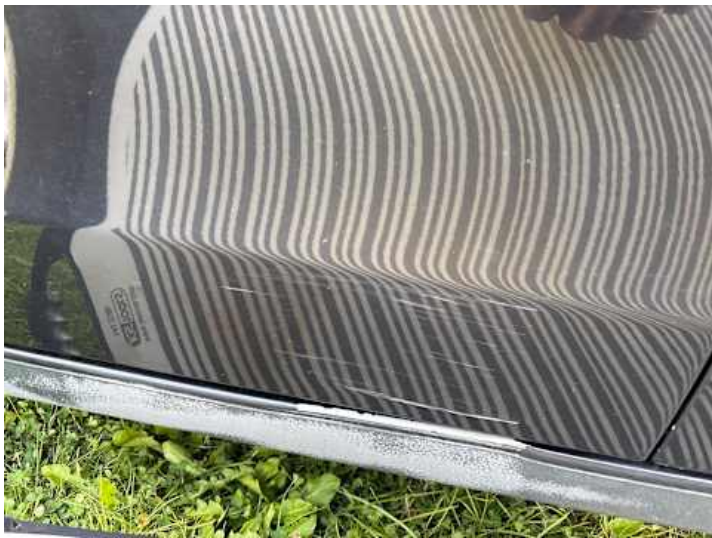
Türe hinten rechts (Verformung)
