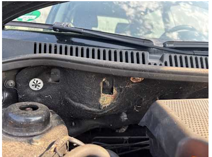
Motorhaube (Anderer Schaden): Dämmung beschädigt
