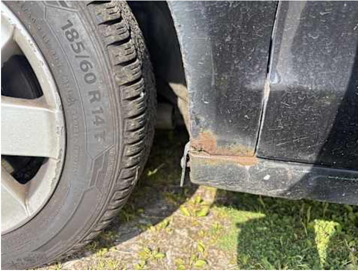
Kotflügel vorne links (Rost)
