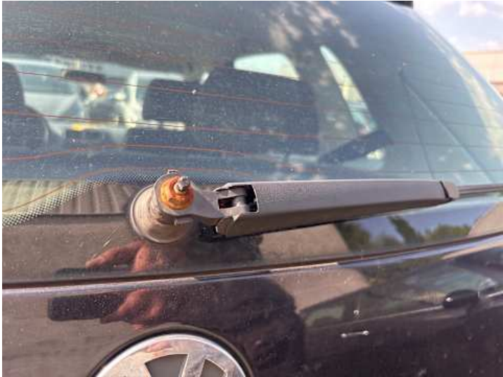
Heckklappe (Anderer Schaden): Kappe fehlt
