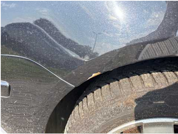
Kotflügel vorne links (Rost)
