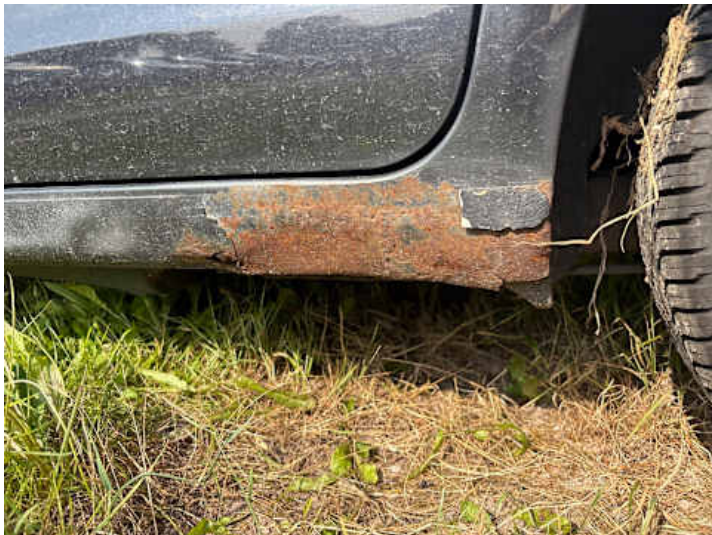
Schweller links (Rost)
