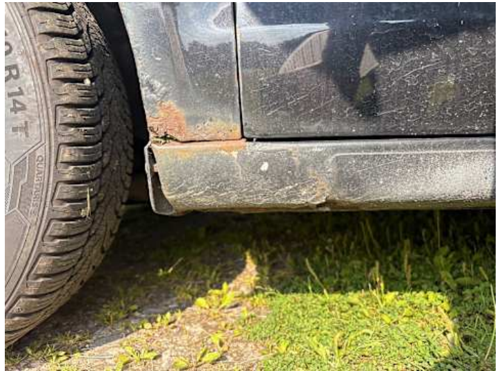
Schweller links (Rost)
