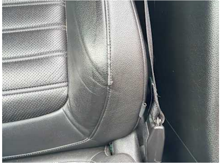
Innenraum (Verschleiß, Verschmutzung)
