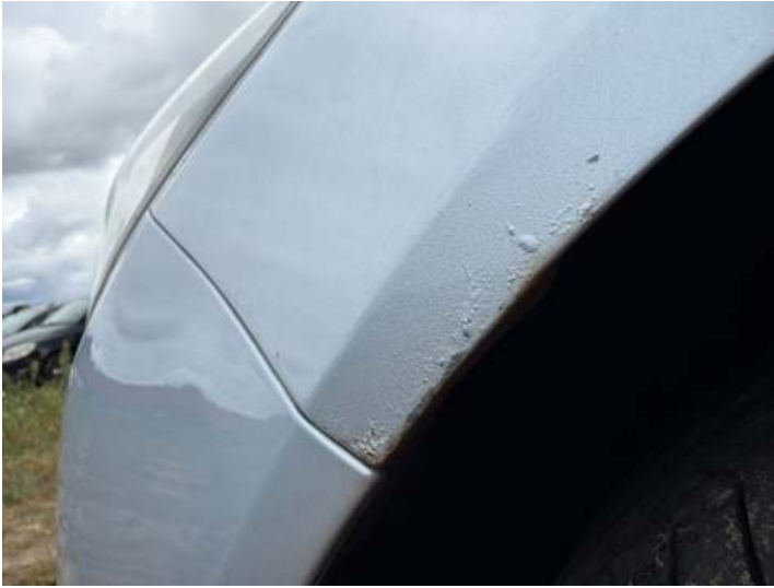
Kotflügel vorne links (Anderer Schaden): Beginnende Korrosion
