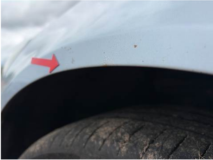
Kotflügel vorne links (Anderer Schaden): Beginnende Korrosion
