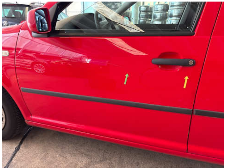
Fahrtür (Delle, Kratzer)
