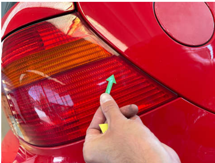
Rücklicht (rechts) (Riss/Bruch)
