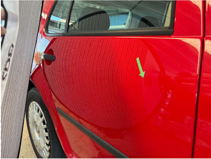
Türe hinten rechts (Delle)
