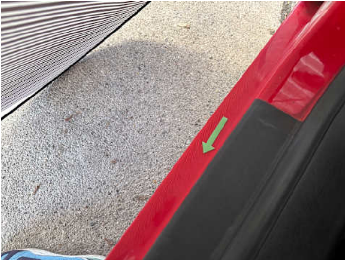
Schweller rechts (Delle)
