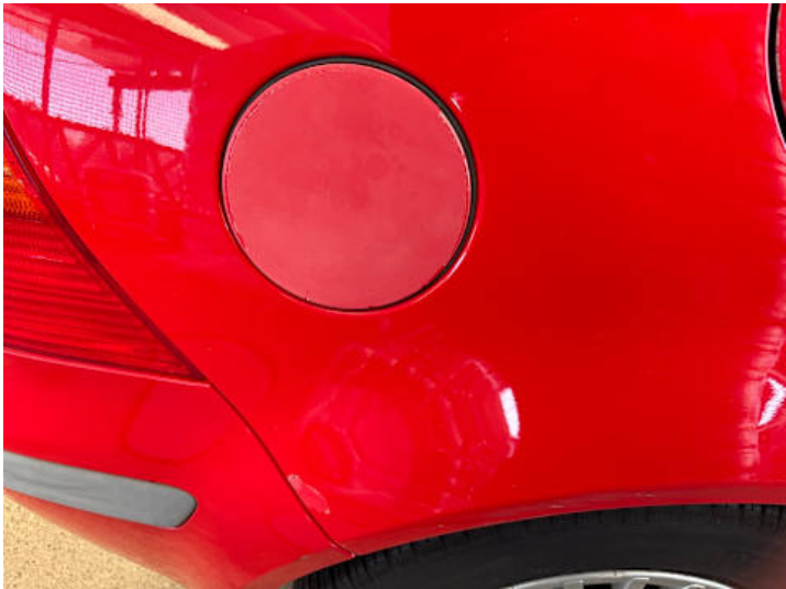
Seitenteil hinten rechts (Verformung, Kratzer)
