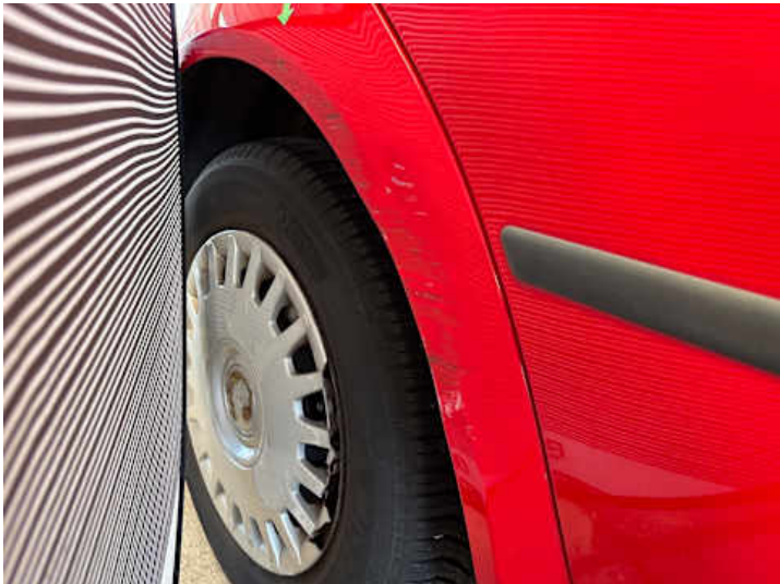
Seitenteil hinten rechts (Verformung, Kratzer)
