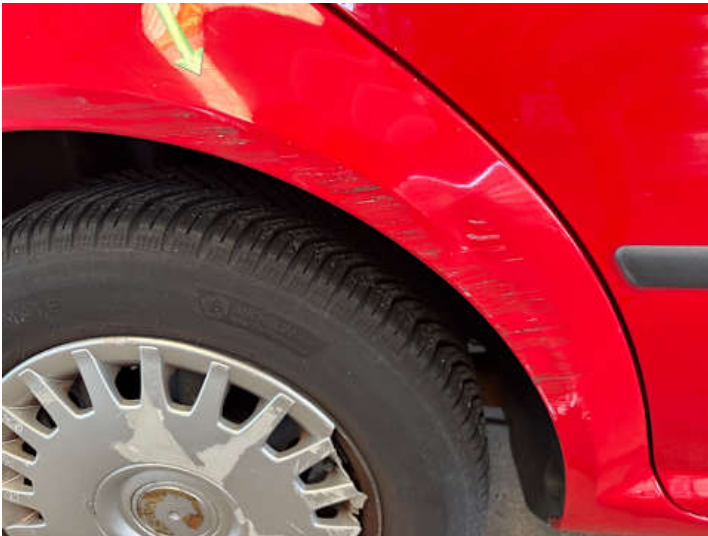
Seitenteil hinten rechts (Verformung, Kratzer)
