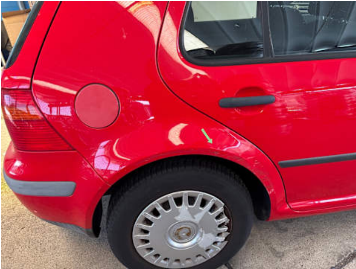
Seitenteil hinten rechts (Verformung, Kratzer)
