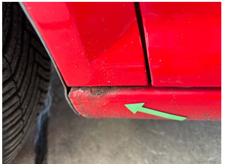
Schweller links (Rost)
