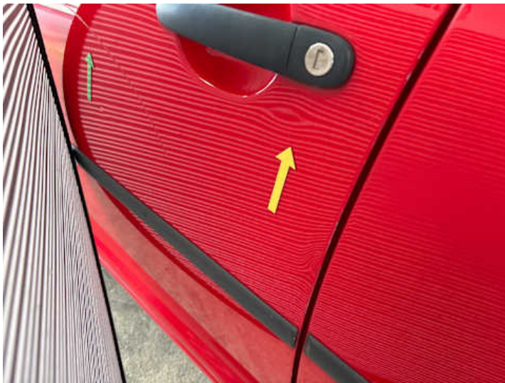
Fahrtür (Delle, Kratzer)
