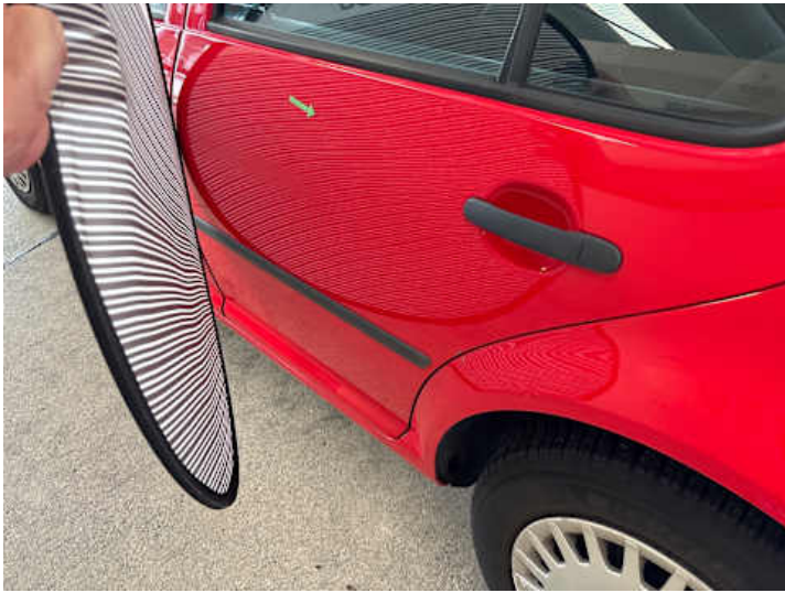
Türe hinten links (Delle, Kratzer)
