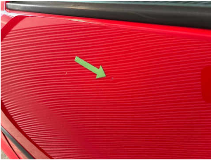
Türe hinten links (Delle, Kratzer)
