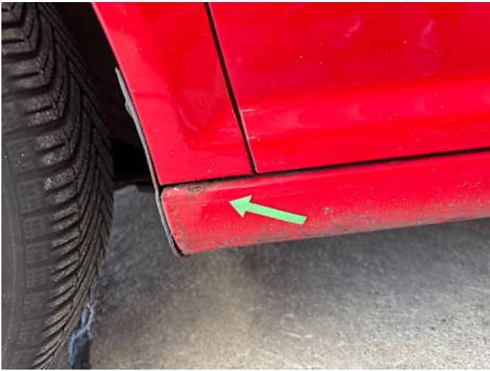
Schweller links (Rost)
