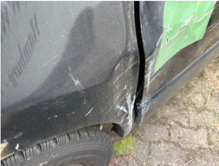
Seitenteil hinten rechts (Kratzer, Verformung)
