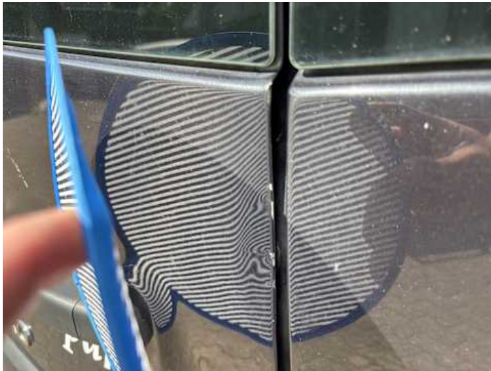
Heckklappe (Verformung, Kratzer)
