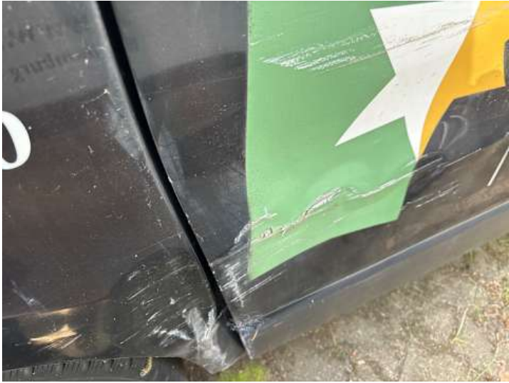
Türe hinten rechts (Kratzer, Verformung)
