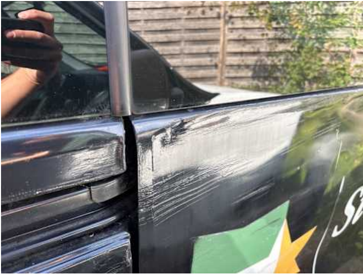
Türe hinten rechts (Kratzer, Verformung)
