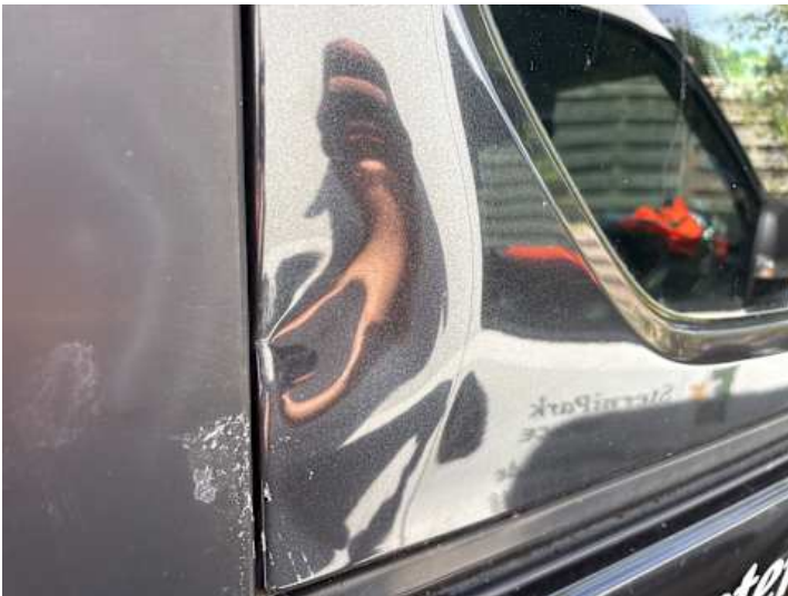
Seitenteil hinten rechts (Kratzer, Verformung)
