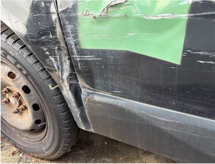
Türe hinten rechts (Kratzer, Verformung)
