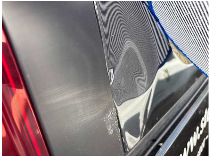
Seitenteil hinten rechts (Kratzer, Verformung)
