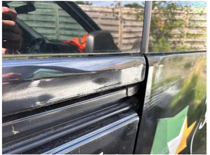
Seitenteil hinten rechts (Kratzer, Verformung)
