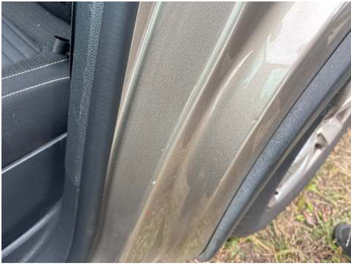
Seitenteil hinten links (Lackschaden, Delle)
