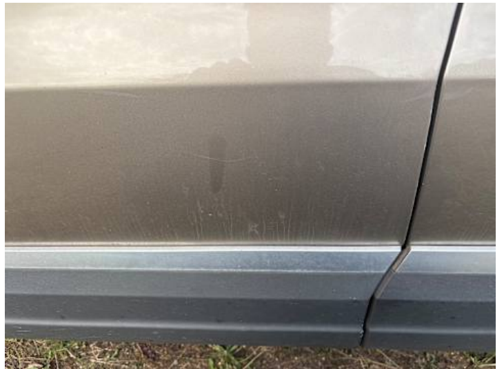
Fahrtür (Lackschaden, Kratzer)
