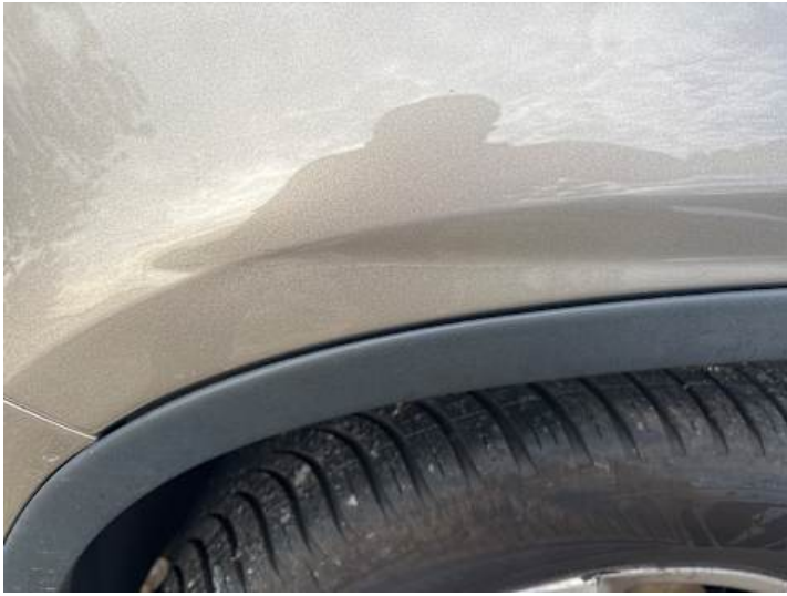
Kotflügel vorne links (Verformung, Kratzer, Spaltmaße ungenau)
