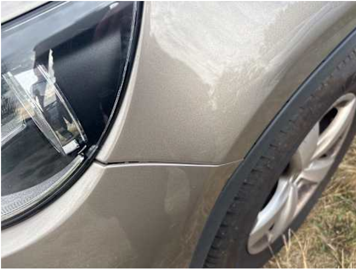
Kotflügel vorne links (Verformung, Kratzer, Spaltmaße ungenau)
