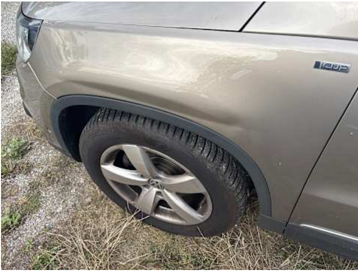
Kotflügel vorne links (Verformung, Kratzer, Spaltmaße ungenau)
