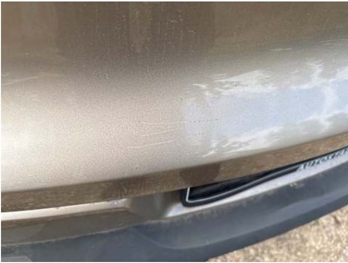
Heckklappe (Delle, Lackschaden, Kratzer)
