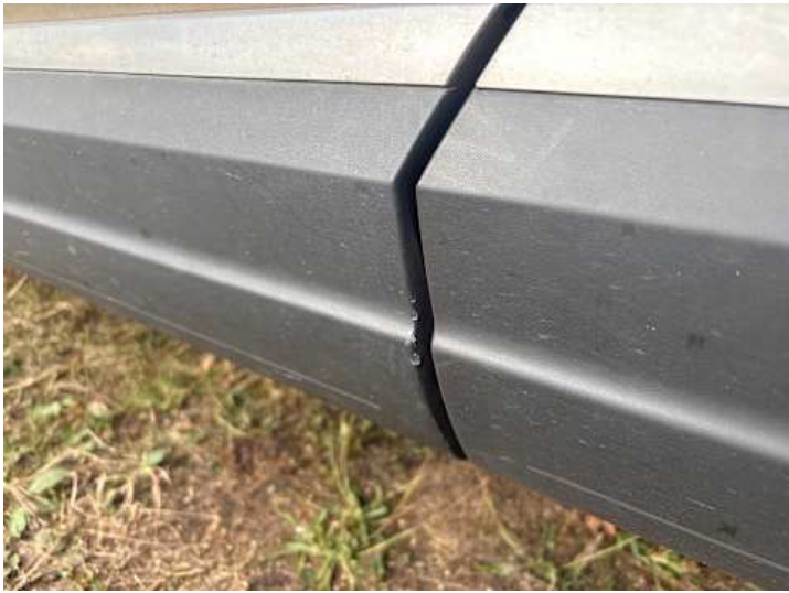
Fahrtür (Lackschaden, Kratzer)
