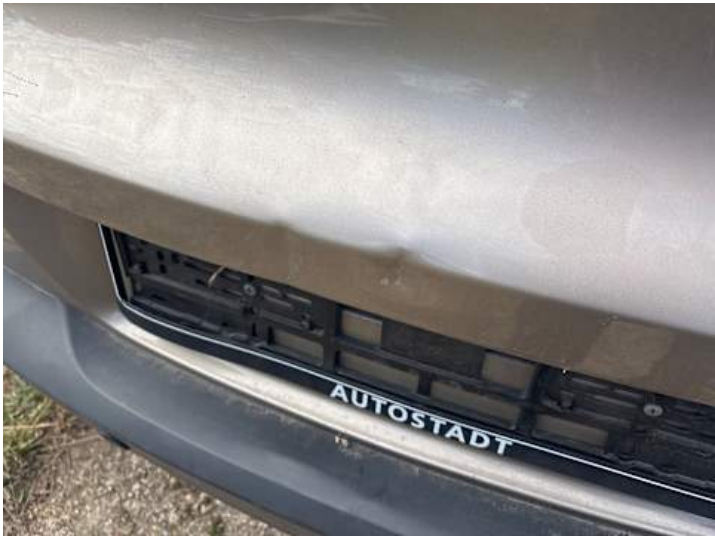
Heckklappe (Delle, Lackschaden, Kratzer)
