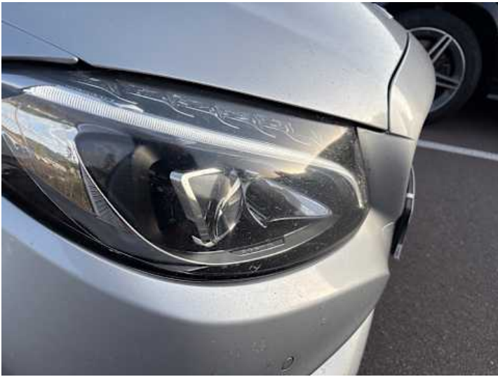
Scheinwerfer (rechts) (Steinschlag)
