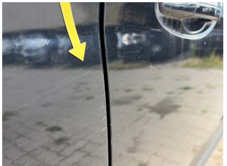
Türe hinten rechts (Kratzer, Riss/Bruch)
