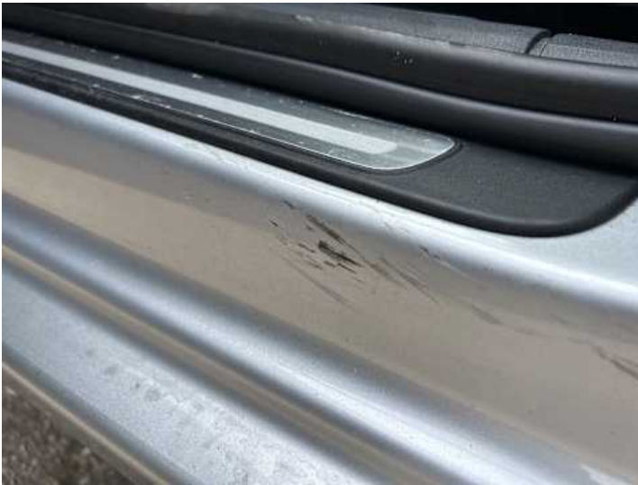
Schweller links (Lackschaden)
