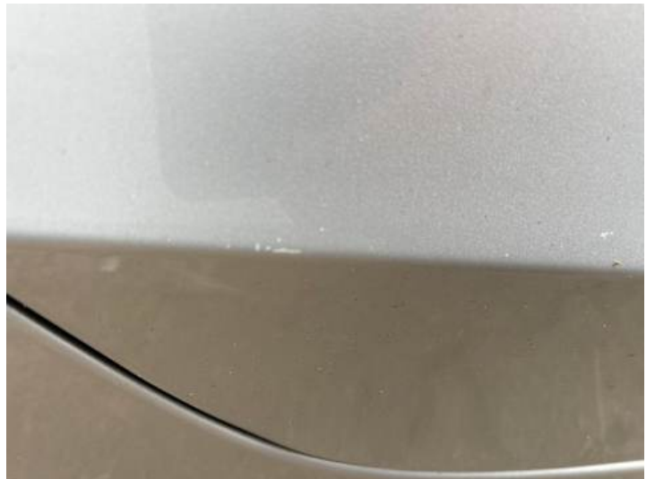
Türe hinten rechts (Lackschaden)
