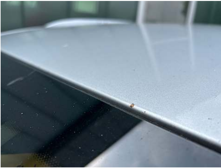
Dach (Lackschaden, Steinschlag)
