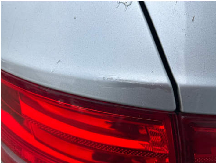
Seitenteil hinten links (Lackschaden)
