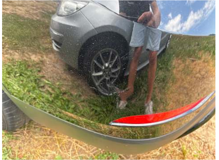
Stoßstange hinten (Verformung, Kratzer)
