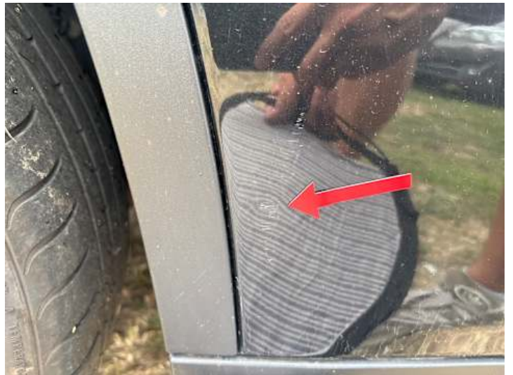
Kotflügel vorne links (Kratzer, Delle)
