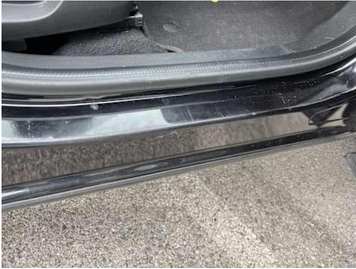
Schweller rechts (Kratzer, Delle)
