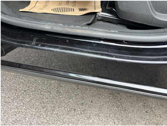
Schweller links (Kratzer)
