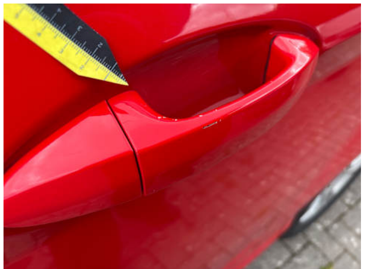
Türe hinten links (Lackschaden)
