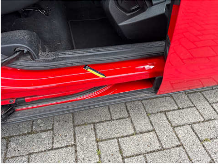
Schweller rechts (Lackschaden)
