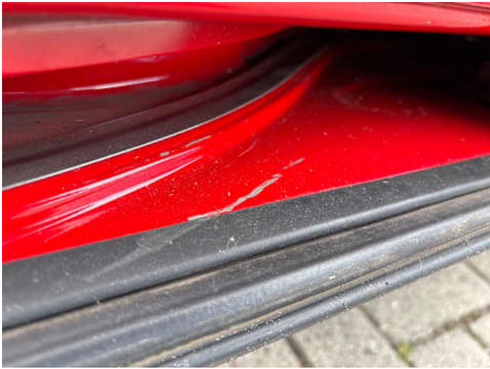
Schweller rechts (Lackschaden)
