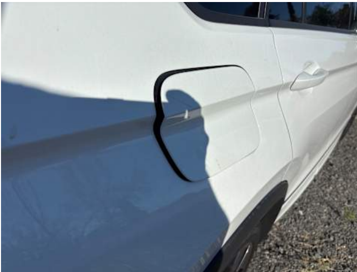
Seitenteil hinten rechts (Anderer Schaden): Tankdeckel schließt nicht mehr,
